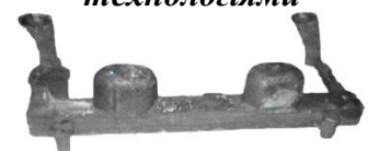
Двошаровий злиток для обробки тиском
