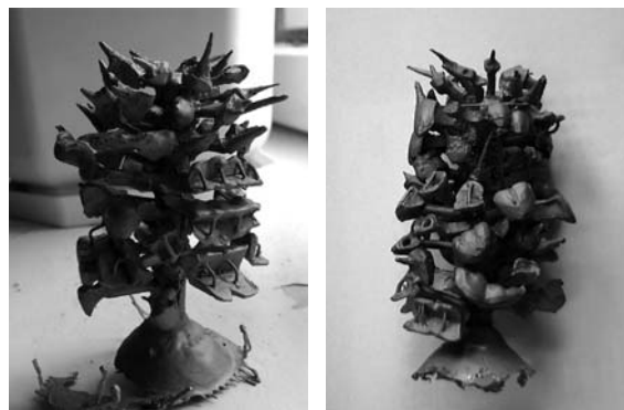
Рис. 3. Отливки с минимальным количеством дефектов (после оптимизации времени виброуплотнения).
