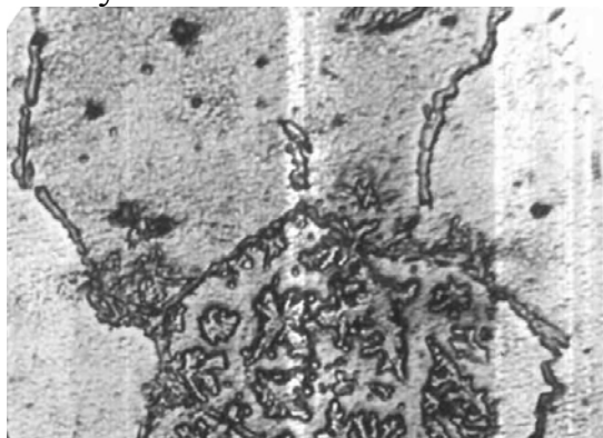
Рис. 2. „Цериевая пористость” в хромоалюминиевой стали 35Х30Ю2ТЛ после обработки 0,5% РЗМ
