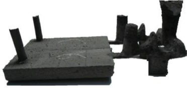
Рис. 12. Вилівок «Плита» з ливниково-модифікувальною системою
