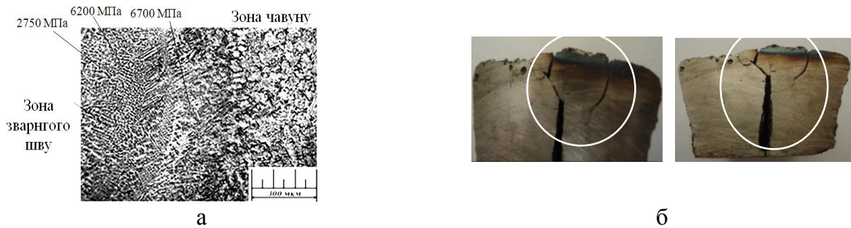
Рис. 23. Мікроструктура перехідної зони зварного з'єднання та сірого чавуну (а), загальний вигляд зруйнованих зразків зварного з'єднання із чавуном після ударного навантаження (б)
