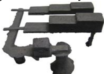
Рис. 3. Здвоєна ступінчаста проба з ливниковою системою
