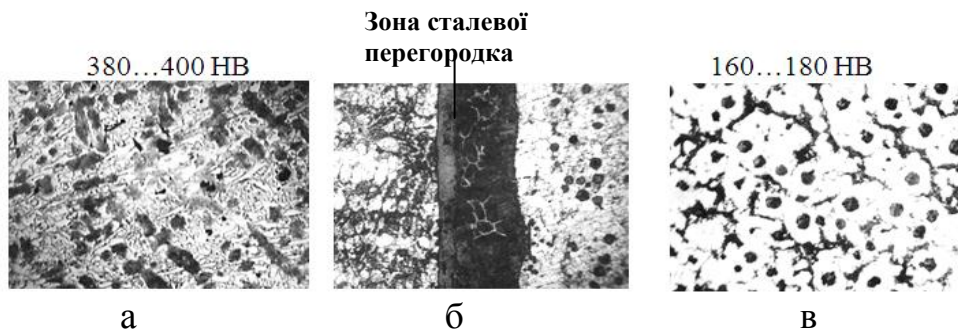
Рис. 25. Мікроструктура лівої (а) перехідної зони (б) та правої (в) частини двошарового виливка після графітизувального відпалу ( \times 100 )
