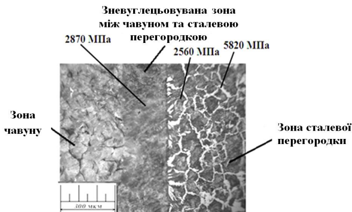
Рис. 17. Мікроструктура перехідної зони у виливку з щільним з'єднанням чавуну і перегородки з сталі Ст08кп покритої шаром цинку
