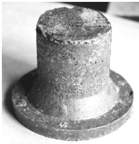
Рис. 1. Виливок деталі з піноалюмінію для гасіння вібрації та енергії удару.
