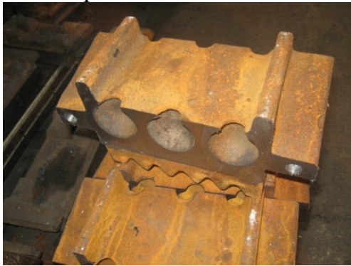
Рисунок 1 – Конструктивний вигляд кокілю для відливання куль та кокіль, розроблений за допомогою програми КОМПАС для лиття чавунних куль, що мелють, діаметром 60 мм
