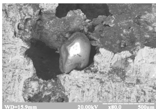
Рис. 5 – Мікроструктура пори виливка з пористого алюмінію з додаванням 1,4% цинку
