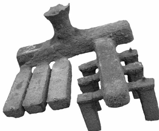
Рис. 1 – Блок зразків після видалення із ливарної форми
