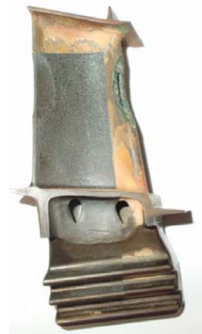
Рис. 4. Результаты удаления продуктов ВТ-коррозии с поверхности лопатки турбины лазерным методом
