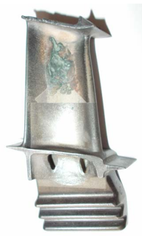
Рис. 3. Результаты удаления эксплуатационного нагара с поверхности лопатки турбины лазерным методом
