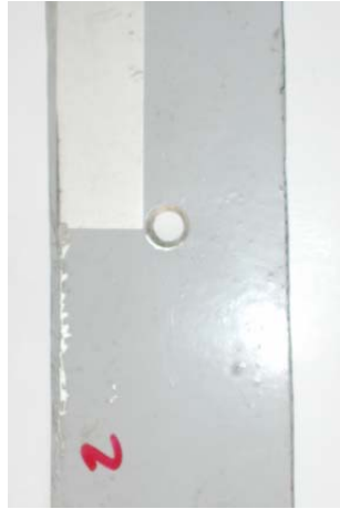
Рис. 2. Результаты удаления ЛКП лазерным методом (крылатая ракета)
