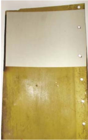
Рис. 1. Результаты удаления ЛКП лазерным методом (МИ-8)
