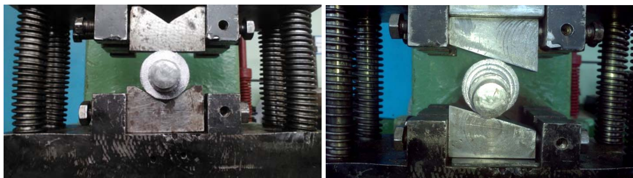
Рис. 1. Схема протяжки на оправке: а – комбинированными бойками; б – скошенными бойками
