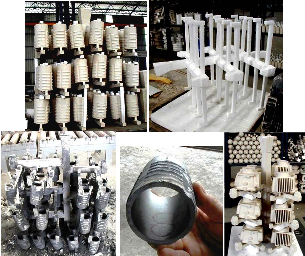
Рис. 1. Примеры конструирования модельных блоков на базе каскадной литниковой системы (фотографии взяты с сайта www.lgm.com.ua )
