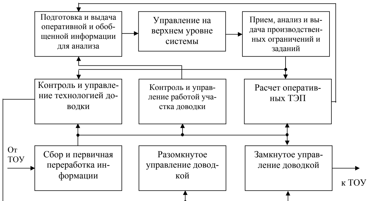
Рис. 1. Функциональная схема АСУТП доводки металла в ковше на АДС
