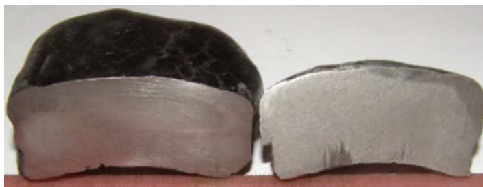
Рис. 3. Макроструктура отриманого вилівка
