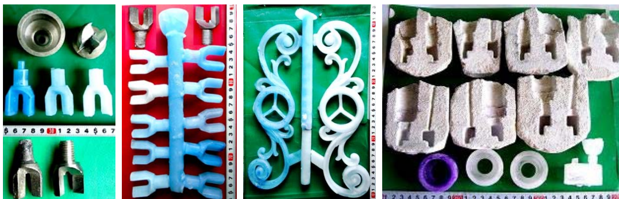
Рис. 1. Ледяные модели и полученные по ним оболочки
