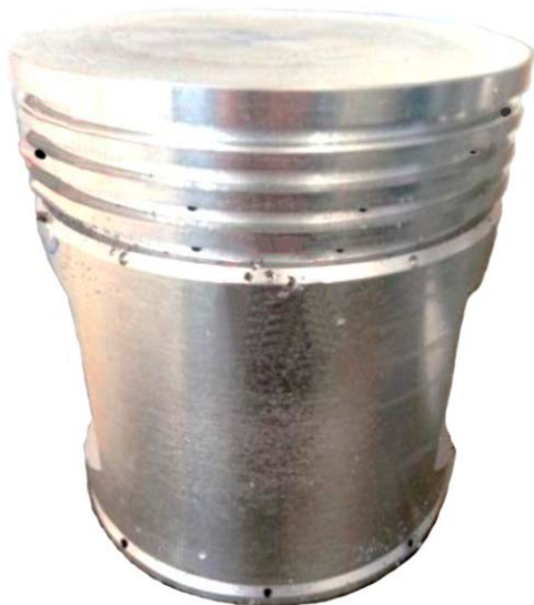
Рис. 1. Поршень із сплаву АК12М2МгН з дефектами у вигляді газової пористості
