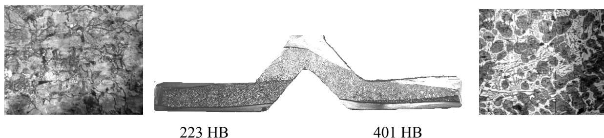
Рис. 9 – Мікроструктура, твердість і колір зламу перерізу двобічної плити з вихідного білого чавуну, ліва частина якого модифікована графітизуючим феросиліцієм ФС75
