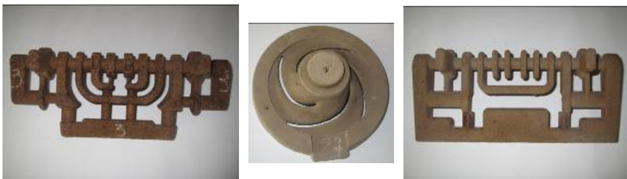
Ливарні стрижні першої групи складності для виливків відповідального призначення, виготовлені із розроблених сумішей
