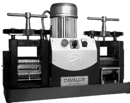
Рис. 6.7. Вальцы двухсторонние с электромеханическим приводом
