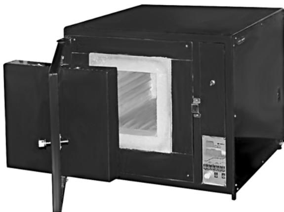
Рис. 5.17. Муфельная печь для обжига опок
