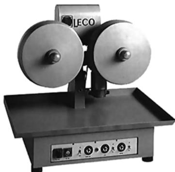
Рис. 10.16. Станок для обработки цепи порошком перед пайкой
