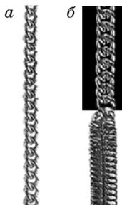
Рис. 10.24. Цепочка до (а) и после (б) уплотнения
