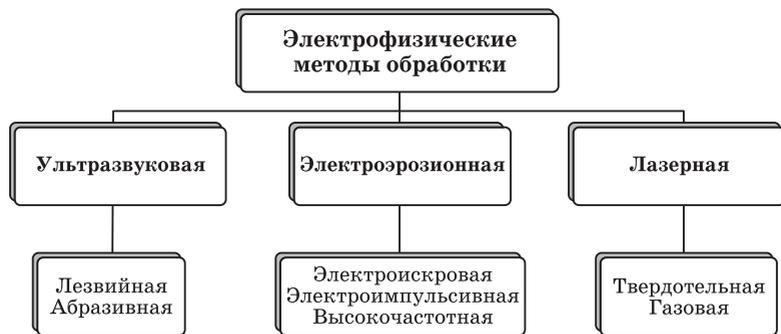
Рис. 13.10. Классификация электрофизических методов обработки в ювелирной промышленности
