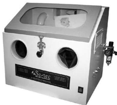
Рис. 7.24. Пескоструйная установка модели 80-ТЕС
