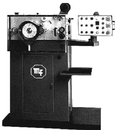
Рис. 10.35. Станок для полировки цепи
