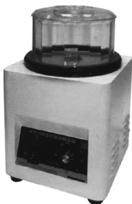
Рис. 7.19. Галтовочный станок для магнитной галтовки
