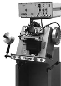
Рис. 10.37. Станок для оконцовки цепочек
