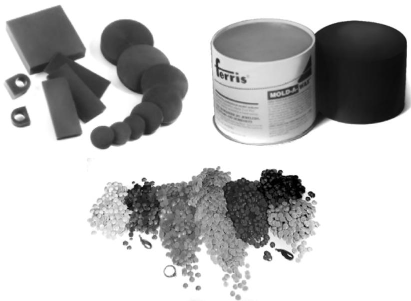
Рис. 2.2. Разновидности восковых заготовок
