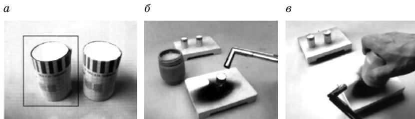
Рис. 5.27. Литье в одноразовые унифицированные формы
