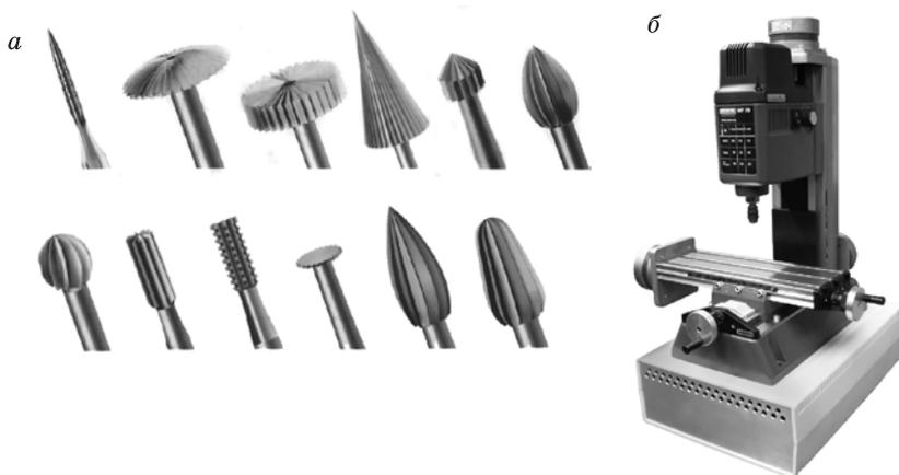
Рис. 7.10. Разновидности борфрез (а) и общий вид микрофрезерных станков (б)
