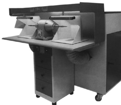
Рис. 7.27. Шлифовальный станок с вытяжкой
