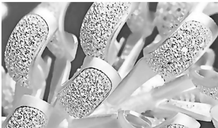
*Рис. 5.28.* Отливки, полученные литьем с камнями
