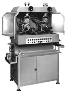
Рис. 10.33. Станок для нанесения алмазной грани
