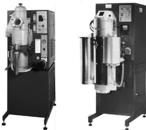
Рис. 5.31. Общий вид индукционных вакуумных машин J-Series Neutec
