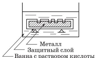
Рис. 13.3. Схема травления
