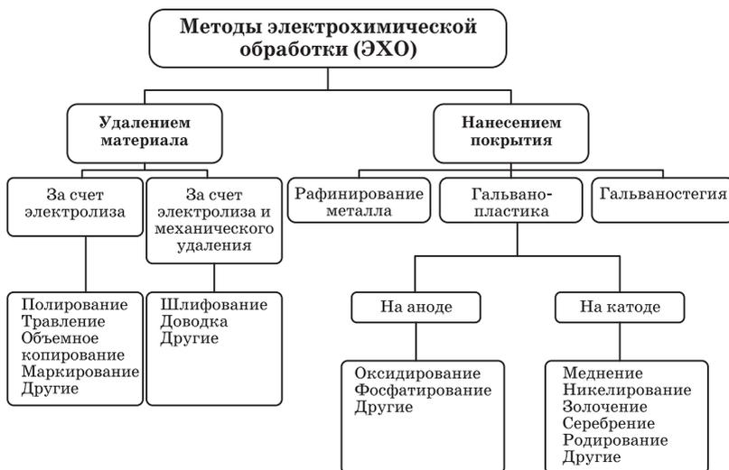
Рис. 13.4. Классификация методов электрохимической обработки
