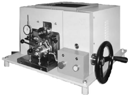
Рис. 16.2. Станок для раскатки колец
