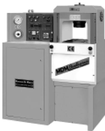
Рис. 6.11. Общий вид гидравлического прессы
