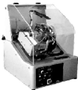
Рис. 10.14. Цепевязальный автомат модели GEKL
