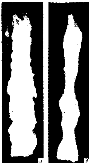
Рис.1. Струя металла, вытекающая из промежуточного ковша через графитошамотовый (а) и циркониевый (б) стаканы
