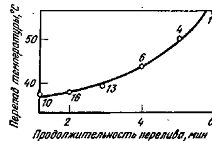
Рис.41. Зависимость тепловых потерь от продолжительности перелива металла при повторной шлаковой обработке (цифры у точек - число плавов)
