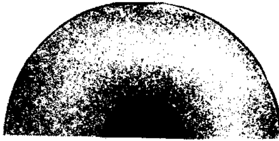
Рис. 46. Макроструктура непрерывнолитой полой заготовки с наружным диаметром 440 и внутренним 130 мм из стали 17Г2С
