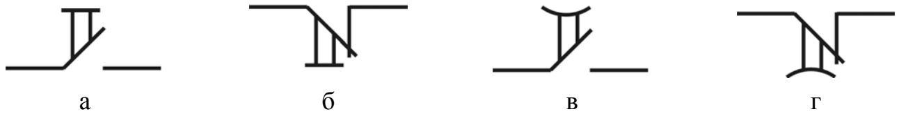
Рис. 2.6. Види контактів у системах автоматики: а – контакт, який замикається, з витримкою на замиканні; б – контакт, що розмикається, з витримкою на розмиканні; в – контакт, що замикається, з витримкою на розмиканні; г – контакт, що розмикається, з витримкою на замиканні
