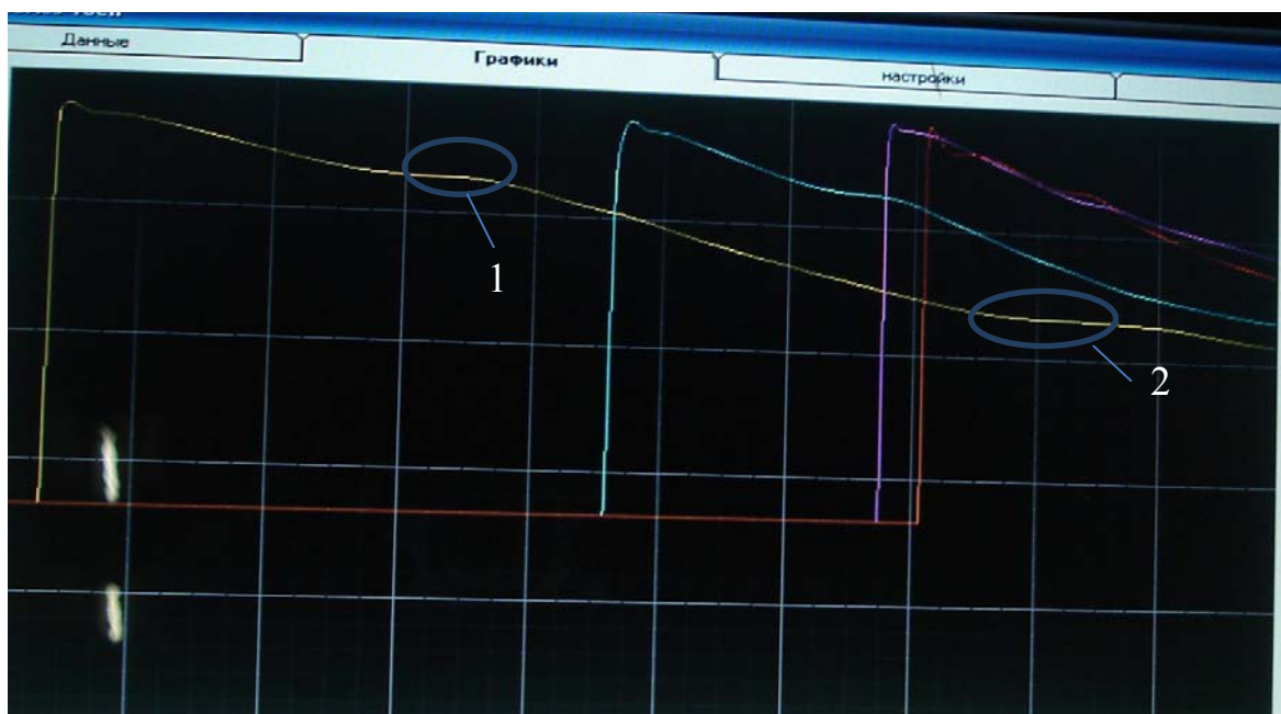
Рисунок 1.2 – Типові криві охолодження
