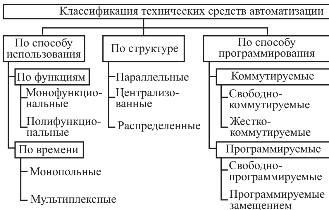
Рис. 1. Классификация технических средств автоматизации технологических процессов
