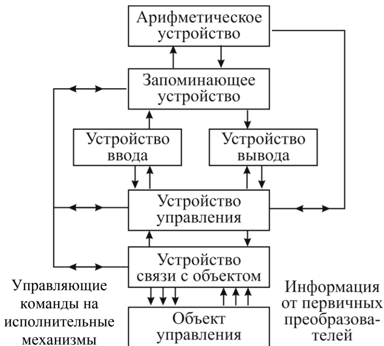
Рис. 33. Укрупнённая схема структуры ЭВМ по А.Г. Староверову
