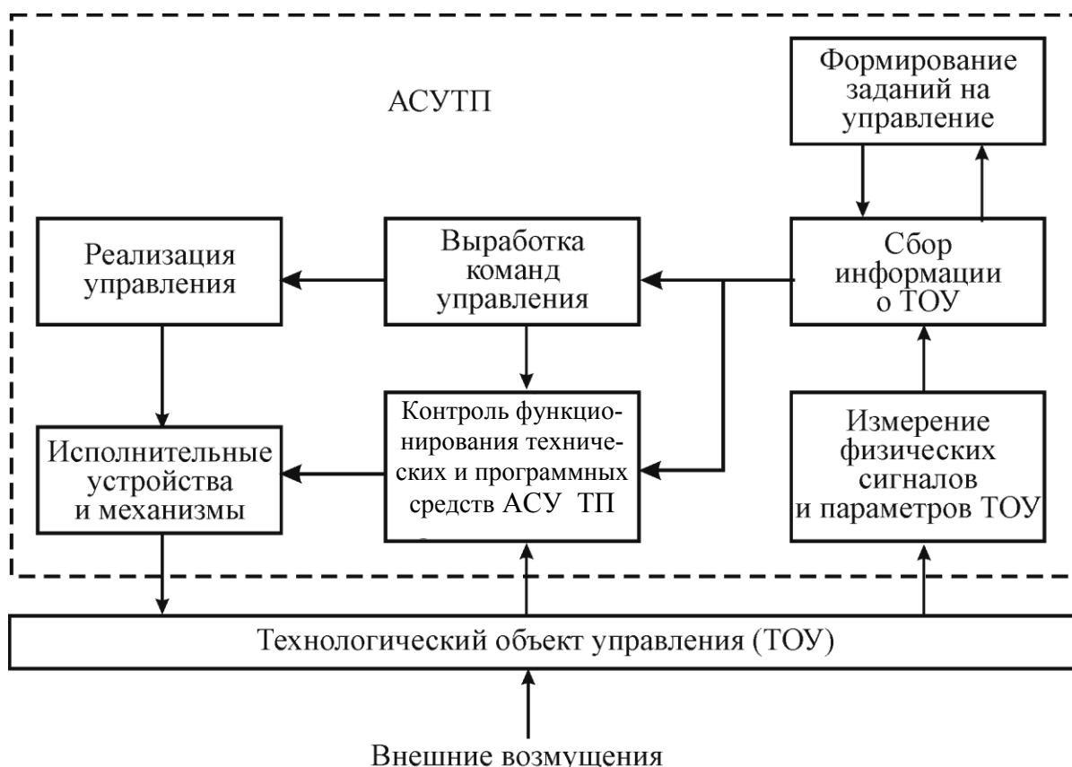
Рис. 41. Обобщённая блок-схема функционирования АСУ ТП
