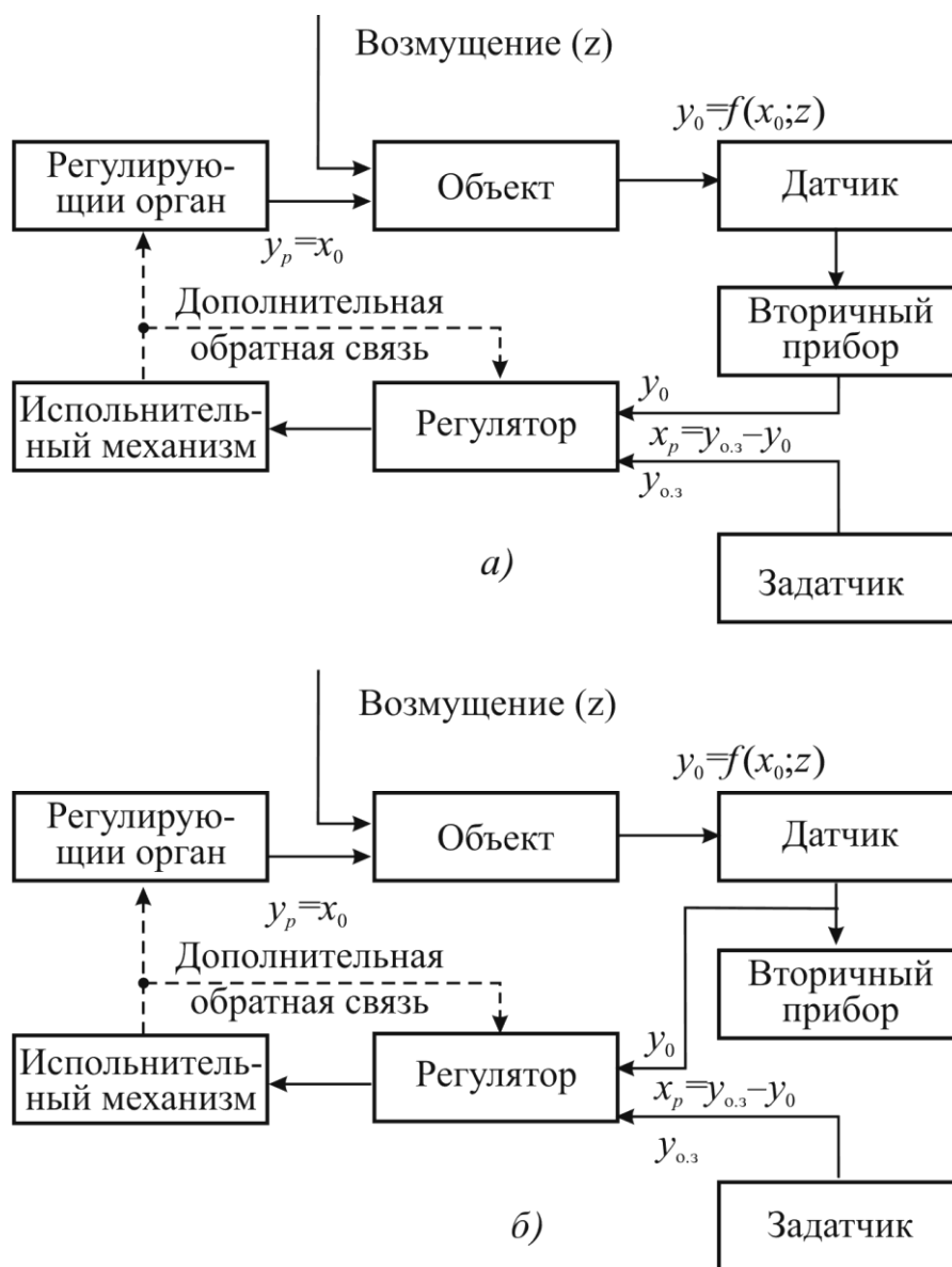
Рис. 6. Блок-схемы САР: а – вторичный измерительный прибор находится в замкнутом контуре; б – вторичный измерительный прибор находится вне контура
