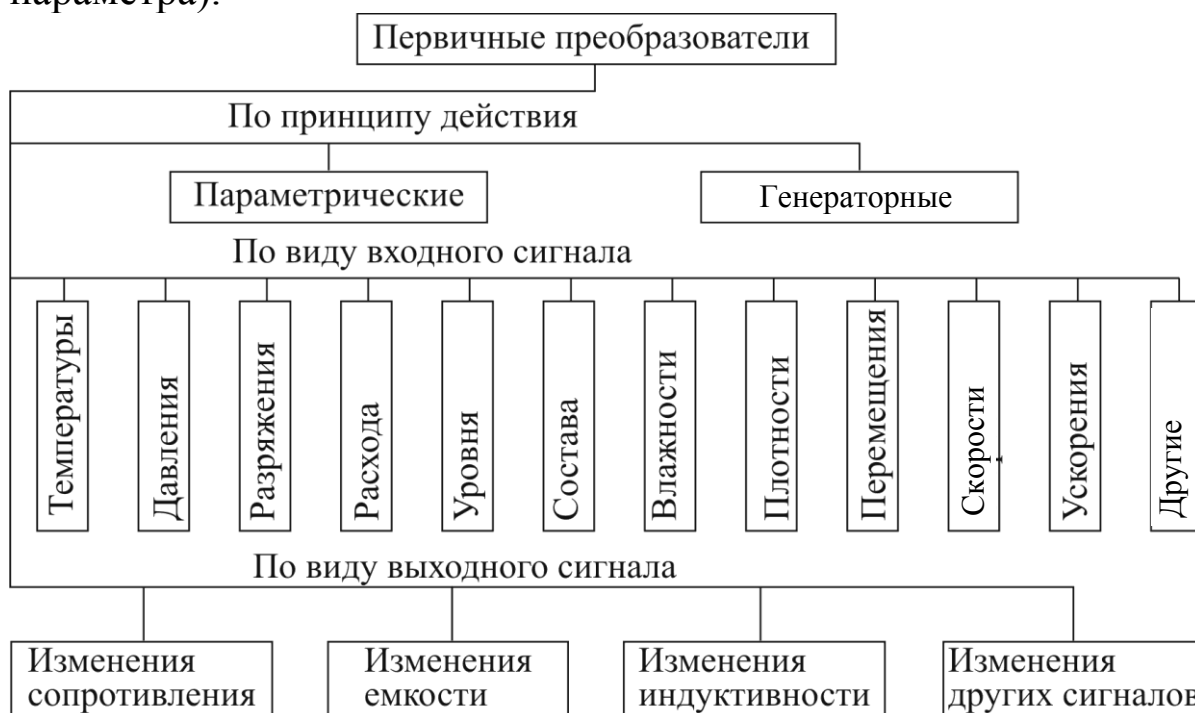
Рис. 16. Классификация первичных преобразователей (датчиков)
