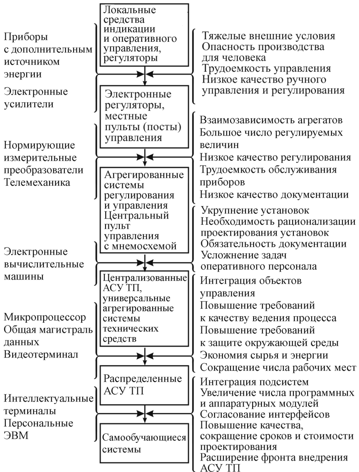
Рис. 2. Схема эволюции систем управления
