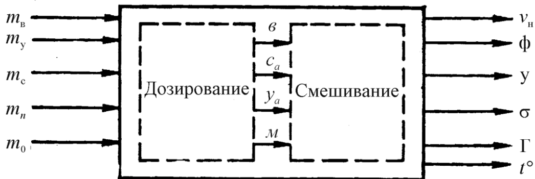
Рис. 69. Упрощённая структурная схема процесса приготовления смеси
