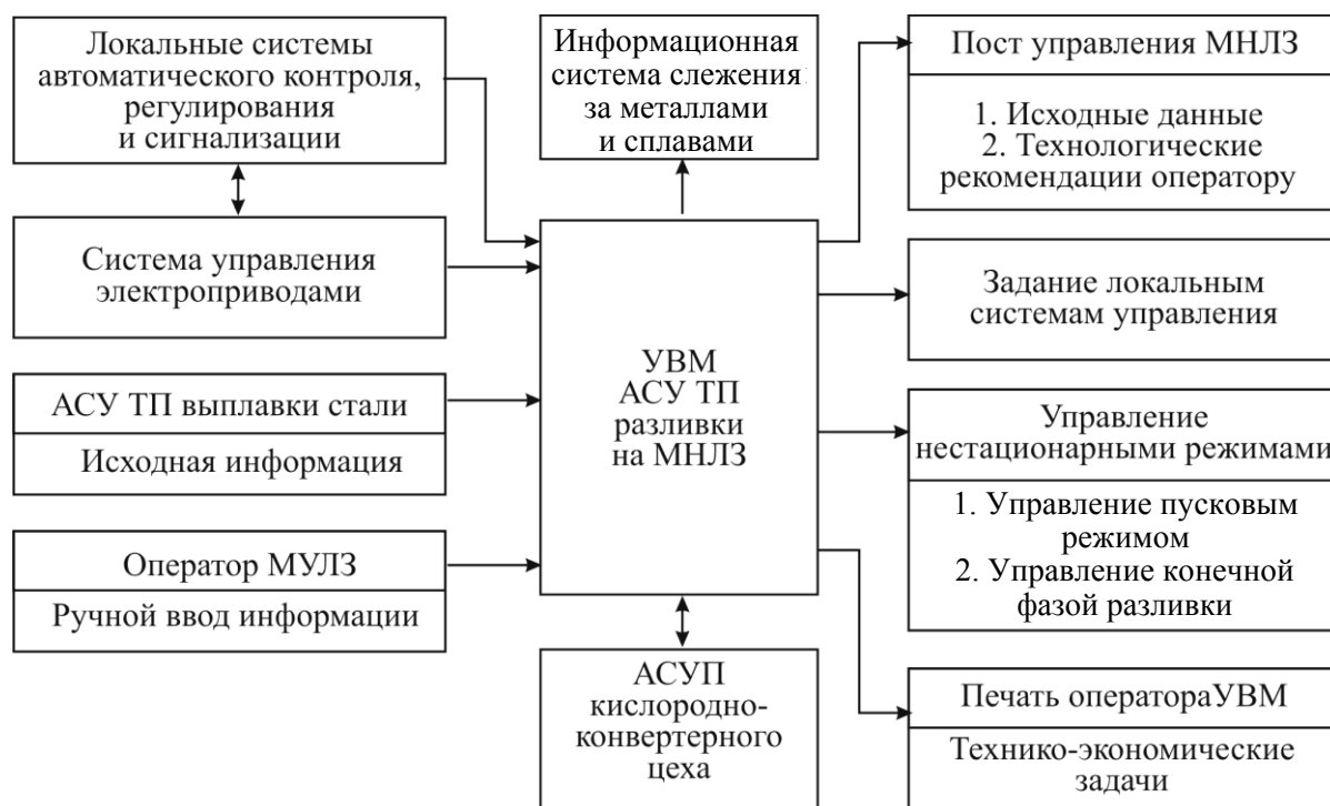
Рис. 102. Схема информационных потоков в АСУ ТП непрерывной разливки стали
