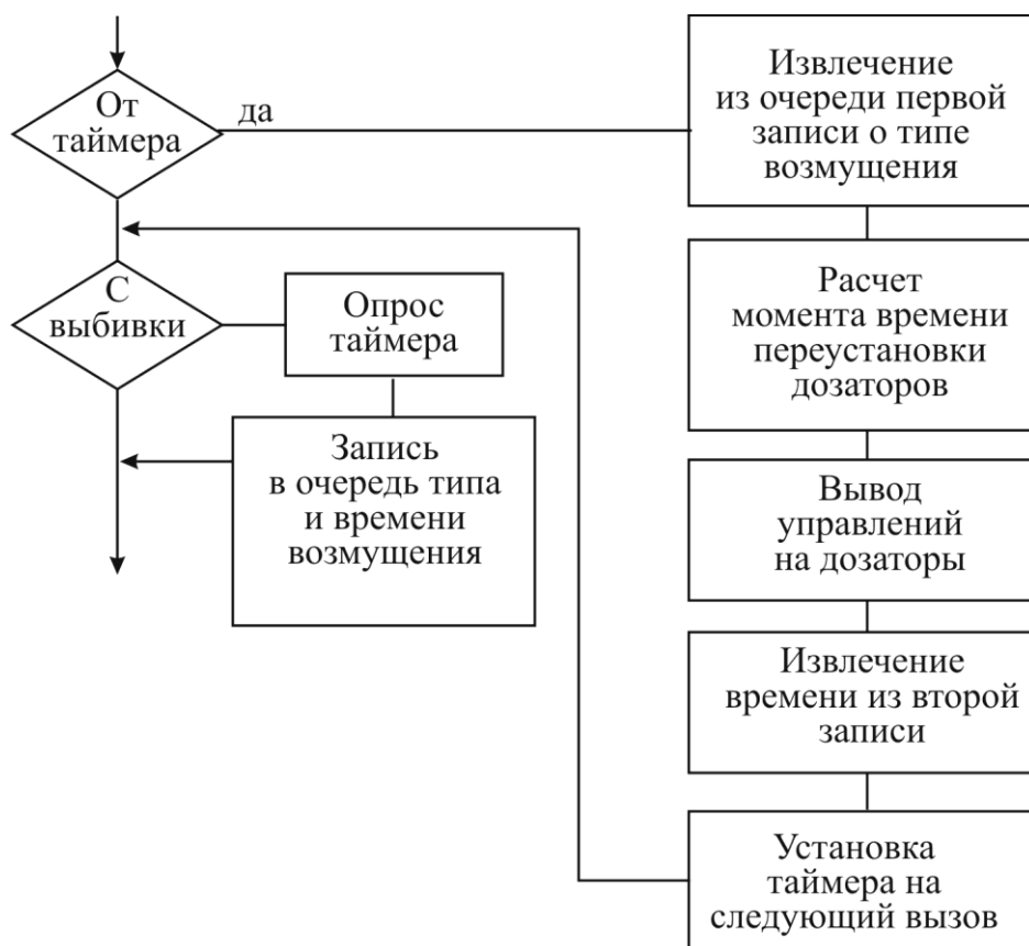
Рис. 72. Алгоритм управления дозатором смесителей по возмущению
