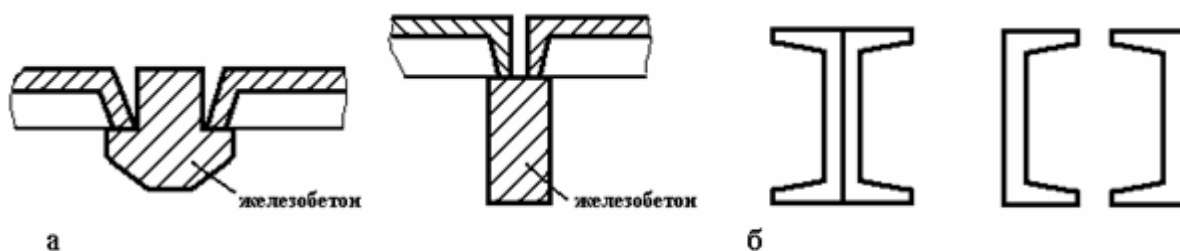
Рис. 17.7. Балочные перекрытия: а – железобетонные; б – стальные
