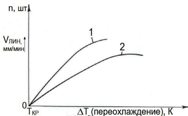
Рис. 34. Зависимость линейной скорости роста кристаллов V_{\text{лин}} (1) и количества центров кристаллизации n (2) от переохлаждения для металлов и сплавов
