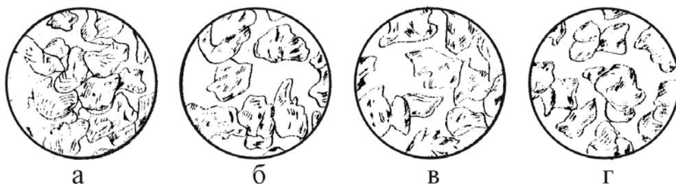
Рис. 2.3. Форма зерен піску: а – округла; б – напівокругла; в – гострокутна; г – складна
