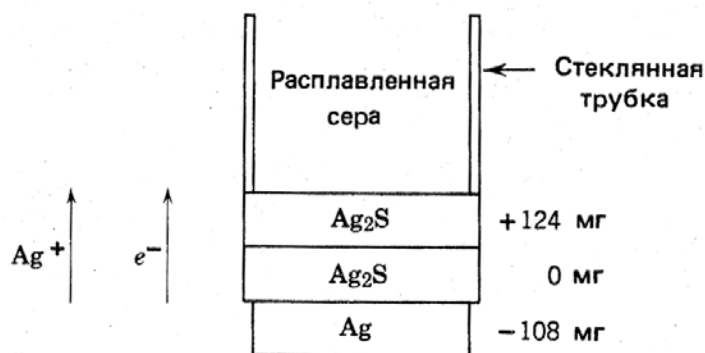
Рис. 32. Схема опыта Вагнера
