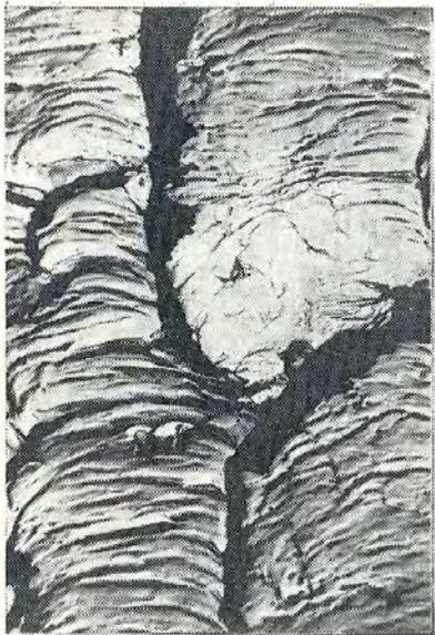
Рис. 48. Фестончатое расположение бороздок в зоне ускоренного развития усталостной трещины (железо),  $\times 9000$
