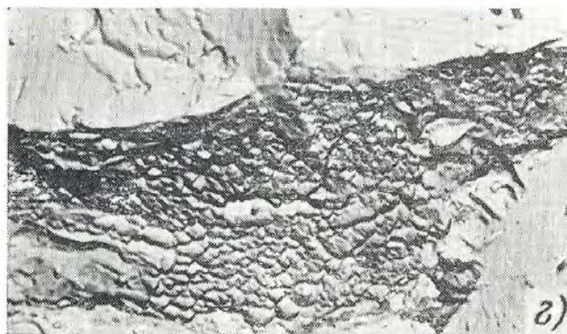
Рис. 29. Микростроение изломов задержанного разрушения стали 45XN2MФА (закалка без отпуски):
