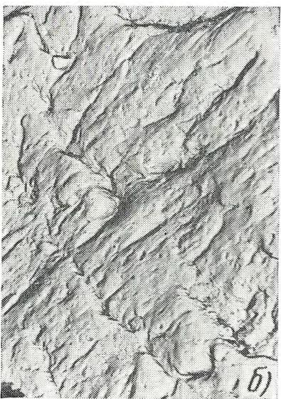
Рис. 59. Электронные фрактограммы усталостных изломов неупрочненных образцов второй разновидности, сталь 45ХН2МФА (мартенсит),  $\times 20000$ :
