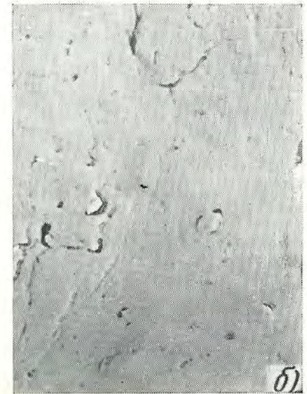
Рис. 53. Микростроение зоны медленного развития усталостной трещины (железо),  $\times 10\ 000$ :
