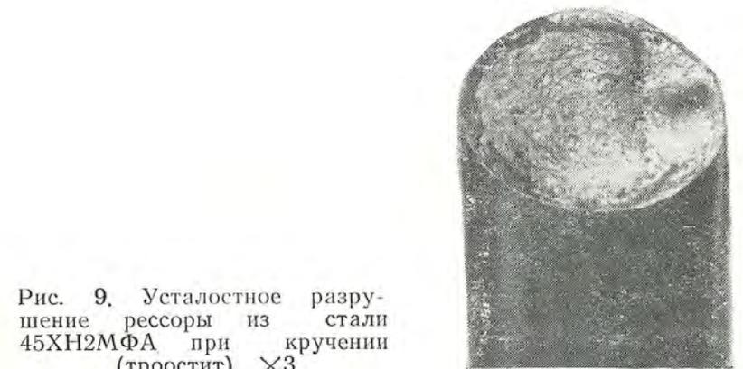
Рис. 9. Усталостное разрушение рессоры из стали 45XN2MΦA при кручении (троостит).  $\times 3$
