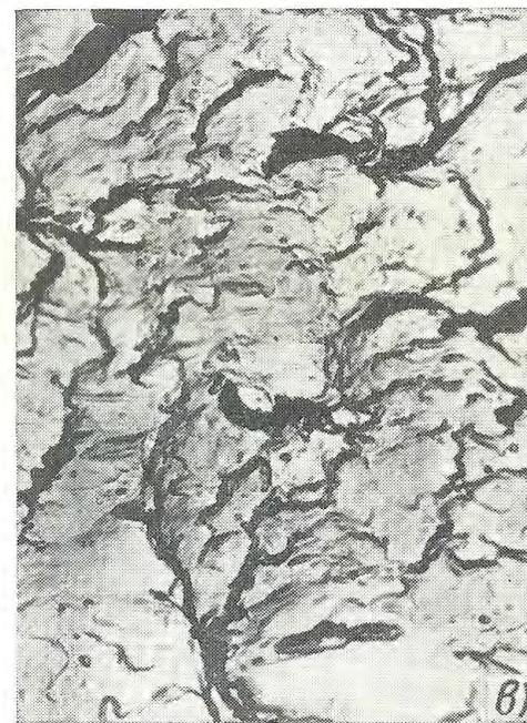
Рис. 135. Разрушение пружины толкателя топливного насоса из стали 50ХФА (троостит):
