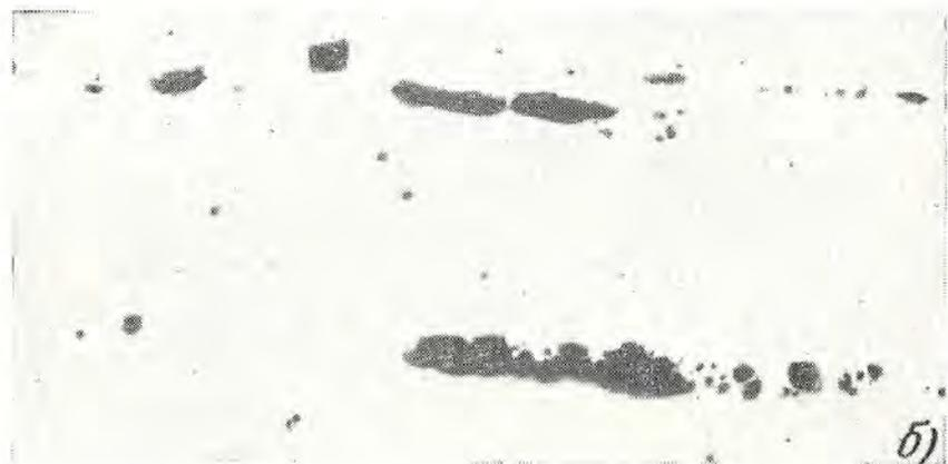
Рис. 96. Трещина в обезуглероженном «мешке» (а) и скопление включений вблизи трещины (б),  $\times 100$
