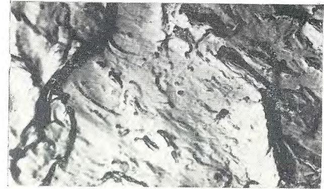
Рис. 142. Микростроение усталостного излома фланца из стали 38ХС (нижний бейнит),  $\times 5000$
