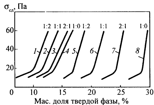
Рис. 1.35. Влияние понизителя вязкости (ПВ), содержания черкасского активированного бентонита и молотого угля на прочность структуры бентонито-угольной суспензии:
