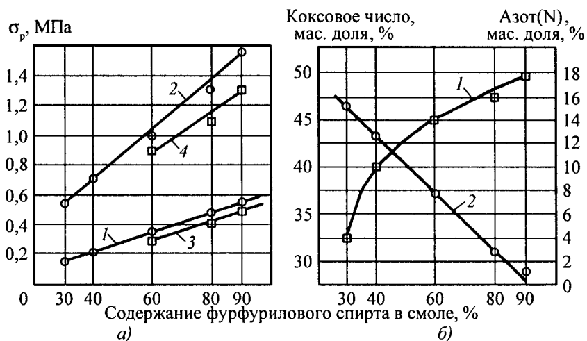
Рис. 2.13. Связующая способность (а), коксовое число и азотсодержание (б) карбамидофурановых смол в зависимости от содержания в них фурфурилового спирта:
