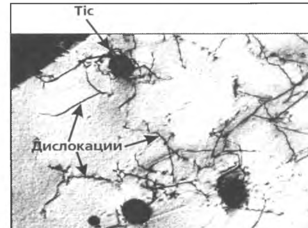
23.6. Скопление дислокаций в нержавеющей стали. Тонкая фольга. ×20 000
