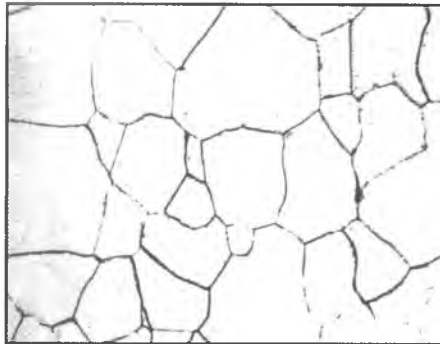
72.1. Техническое железо 0,01%С. ×100
