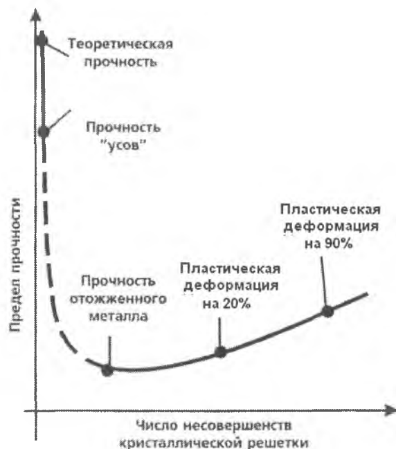
Рис. 2.3. Зависимость предела прочности от несовершенств кристаллической решетки. (Кривая Оudinга).
