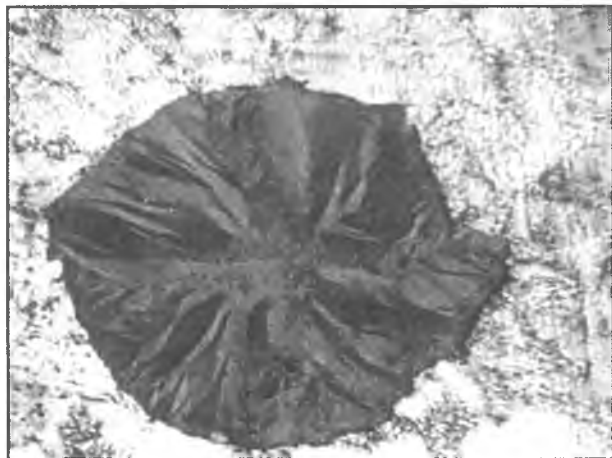
54.4. ×500 Шаровидный графит (сферокристалл) в магниевом чугуне.
