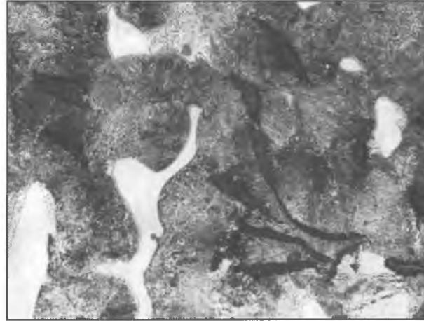
62.2. ×100 Конечная графито-перлитно-цементитная структура.
