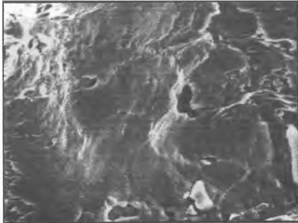
88.3. Усталостное разрушение после ВТМО и отпуска, Тисп = + 20 °С. ×8 000
