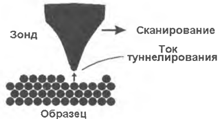
Рис. 7.7. Принцип действия сканирующего туннельного микроскопа (по Хоникомбу).
