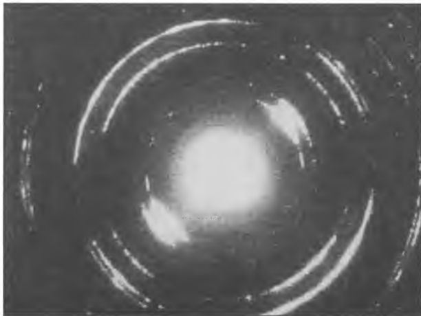
24.4. Электроннограмма с электролитически осажденного никеля, толщина 2 мкм.
