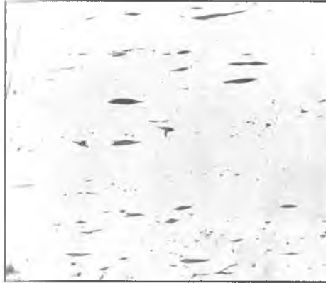
53.1. × 100 Сульфиды (светлые) + силикаты пластинчатые (темные).
