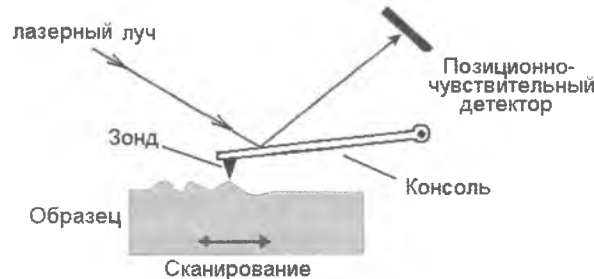
Рис. 7.10. Схема работы атомно-силового микроскопа. [101].
