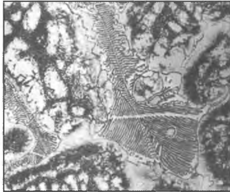
82.6. Структура литой стали. ×100
