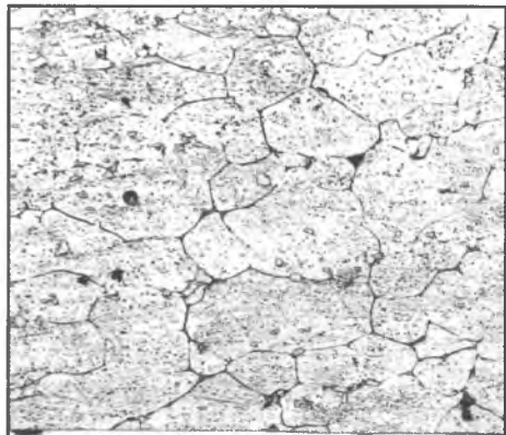
28.1. Дюралюминий марки Д1 (система Al – Cu – Mg – Si). ×100
