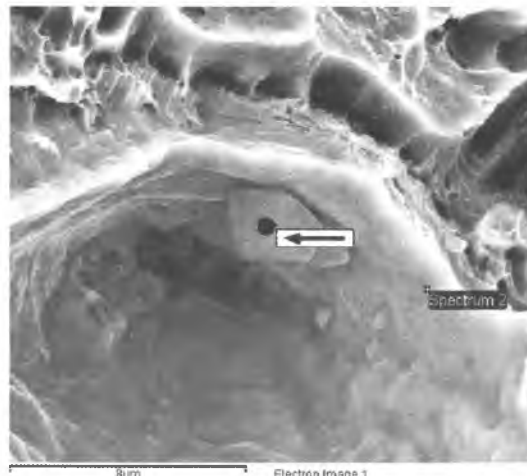
89.2. Участок, выделенный на рисунке 89.1, содержащий частицу №1.
