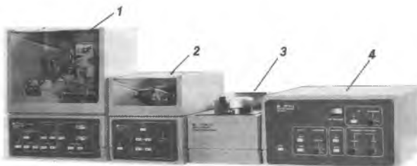
Рис. 1.2. Прибор для приготовления тонких фольг из металлов и сплавов ПТФ-3, который выпускает объединение «Электрон», г. Сумы. 1 – устройство электроискровой отрезки; 2 – устройство для механической шлифовки дисков; 3 – устройство струйной электролитической полировки; 4 – блок управления.
