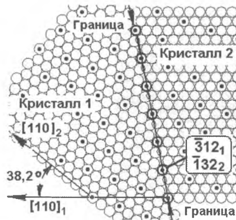
115.5. Граница между кристаллами проходит по плотноупакованной плоскости РСУ.
