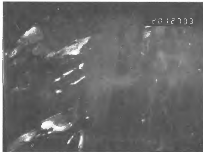
126.3. Темнопольное изображение в рефлексе решётки с осью зоны [100] , \times 15\ 000
