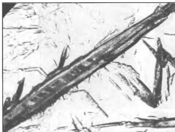
78.6. Следы деформации в аустените. \times 500
