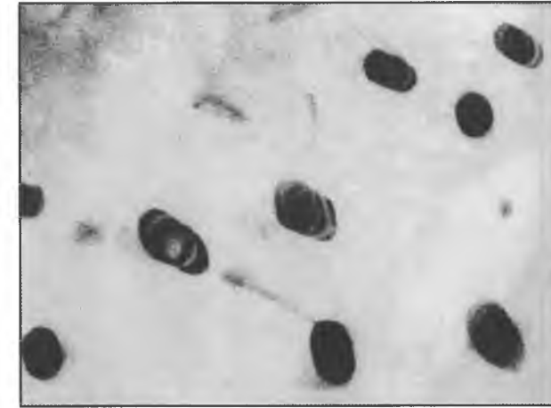
128.6. Стержневой цементит. Цилиндрическая форма отрезков стержней в тонкой фольге (см. 128.5). ×60 000
