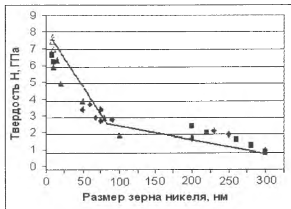
158.4. Твёрдость горячепрессованного никеля в зависимости от дисперсности частиц.
