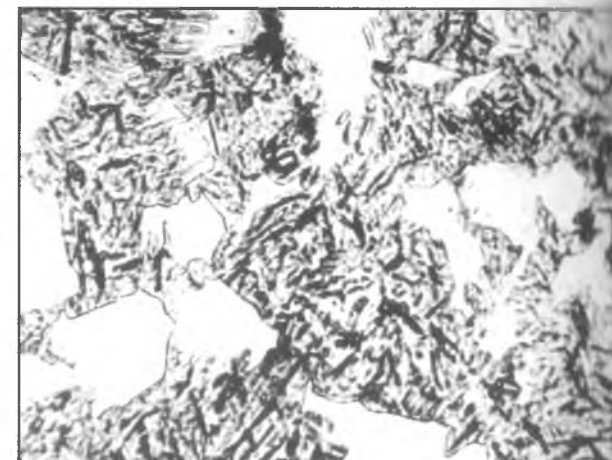
84.3. ×100 Неполная закалка конструкционной стали.
