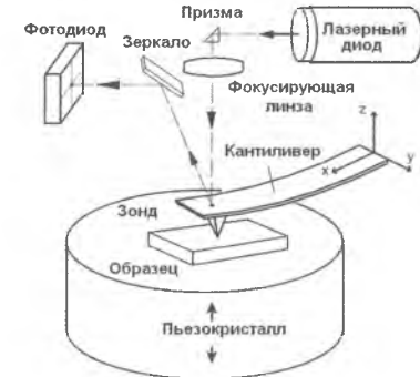
Рис. 7.11. Схема расположения элементов конструкции АСМ.
