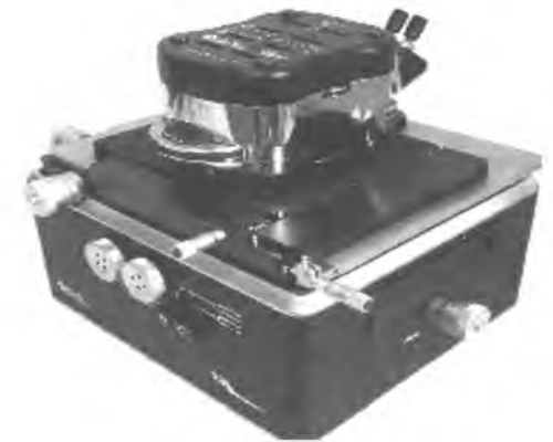
Рис. 7.12. Внешний вид атомно-силового микроскопа.
