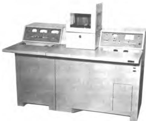
Рис. 1.1. Многоцелевой вакуумный пост ВУП-4К для препарирования электронномикроскопических образцов
