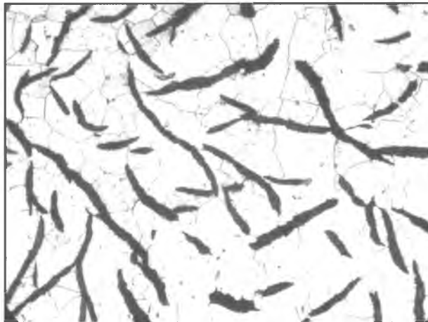
54.2. ×100 Пластинчатый графит в сером чугуне.
