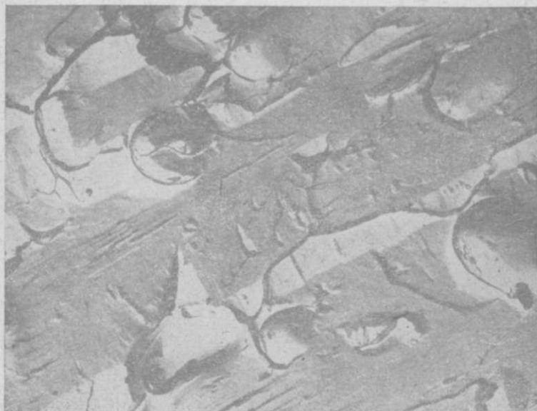
Рис. 24. «Подлинный» столбчатый излом с «потоками» и «языками» марганцеванадиевой стали, полученный при температуре -196^\circ , ( \times 30\ 000 ).
