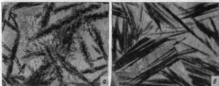
Рис. 292. Пачки верхнего (а, выдержка при 300 °С) и нижнего (б — выдержка при 250 °С) бейнита. Травление \text{HNO}_3 , \times 1500
