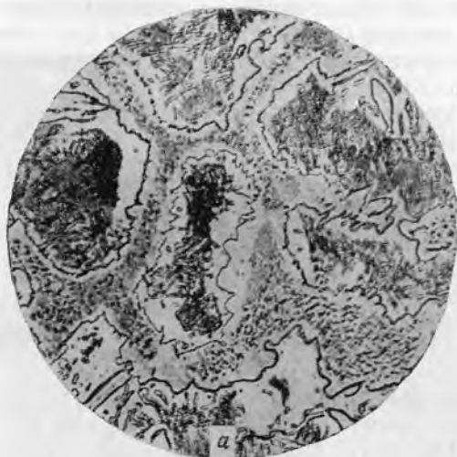
Рис. 156. Эвтектика в быстро охлажденном чугуне с 1,5% С и 5,8% Si: а — \times 600 ; б — \times 1500 — травлено HNO_3 ; в — то же, тепловое травление, \times 1300
