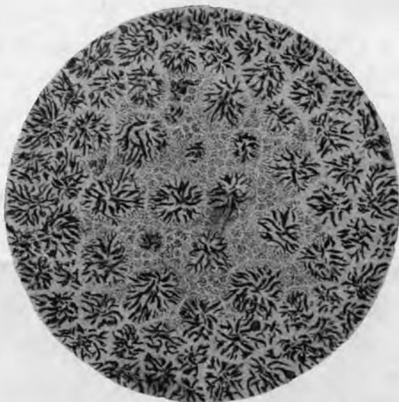
Рис. 207. Схема изменения структуры графитной эвтектики по сечению цилиндрической отливки
