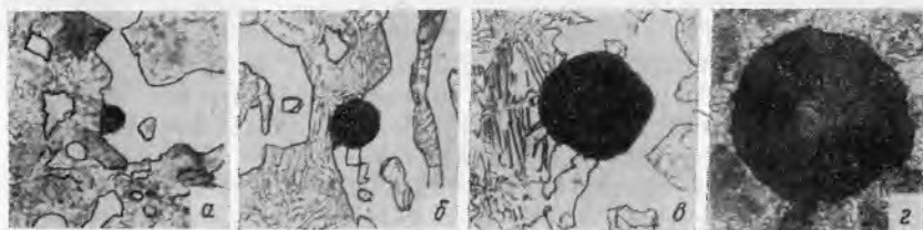
Рис. 239. Последовательные этапы роста шаровидного графитного включения. Травление \text{HNO}_3 , \times 1200
