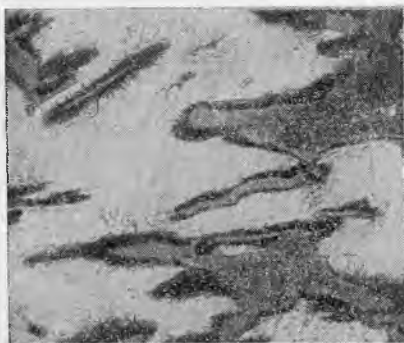
Рис. 155. Белый чугун. Травление пикратом натрия. \times 600
