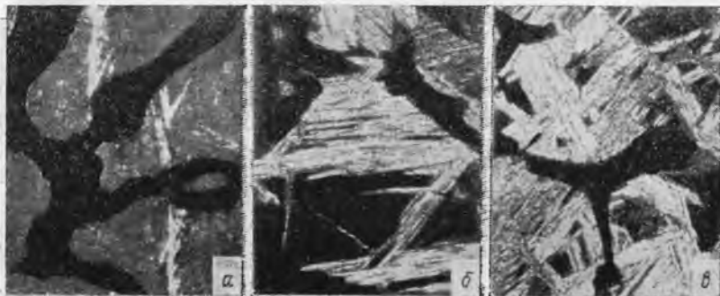
Рис. 293. Распад аустенита при 250 °С при выдержке: а — 6 ч (появление первых пачек нижнего бейнита); б — 18 ч (полураспад аустенита); в — 22 ч (непревращенными остаются небольшие участки аустенита), скрещенные никели. Травление \text{HNO}_3 , \times 500
