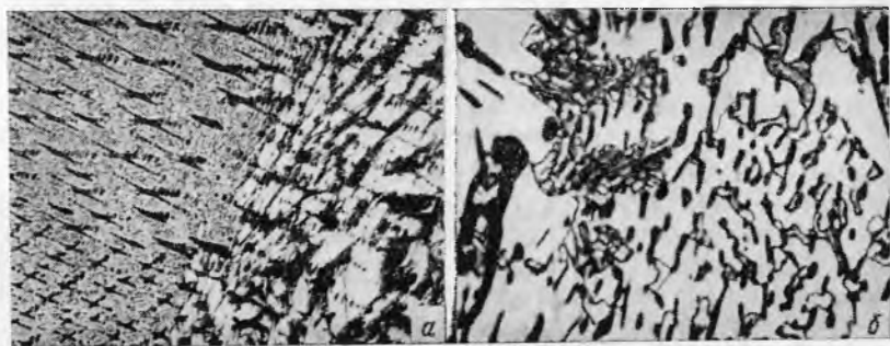
Рис. 161. Тройная квазиэвтектика в быстроохлажденном сплаве с 3,0% C и 6,0% Si. Тепловое травление: а — \times 100 ; б — \times 1500
