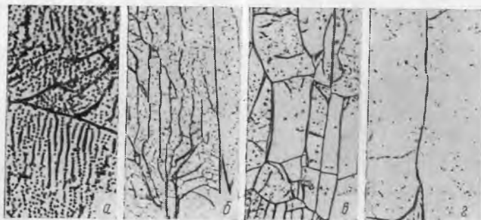
Рис. 350. Структурные изменения при полигонизации и рекристаллизации кремнистого феррита. Электролитическое травление, \times 1000
