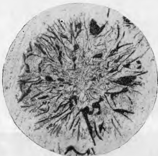
Рис. 69. Колония А+Г в эвтектическом чугу- не, закаленном в ходе затвердевания. Травле- ние \text{HNO}_3 , \times 100
