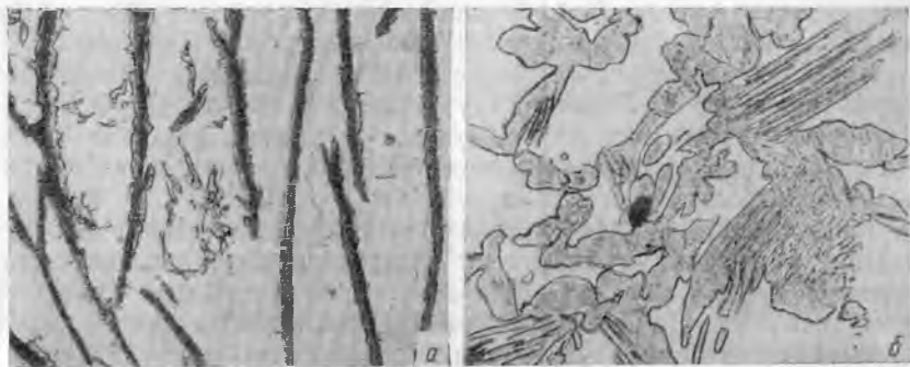
Рис. 307. Аустенит в виде оболочки около пластин графита (а — \times 100 ) и в виде пластин (б — \times 300 ). Травление HNO_3
