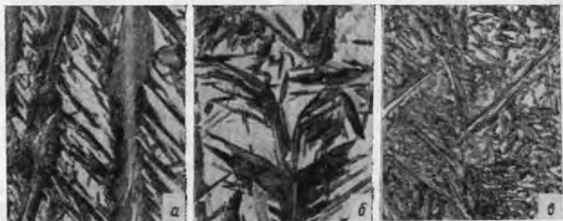
Рис. 295. Мартенсит в чугуне, закаленном после выдержки при различных температурах, °С: а — 200; б — 300; в — 400. Травление \text{HNO}_3 . \times 1300 .
