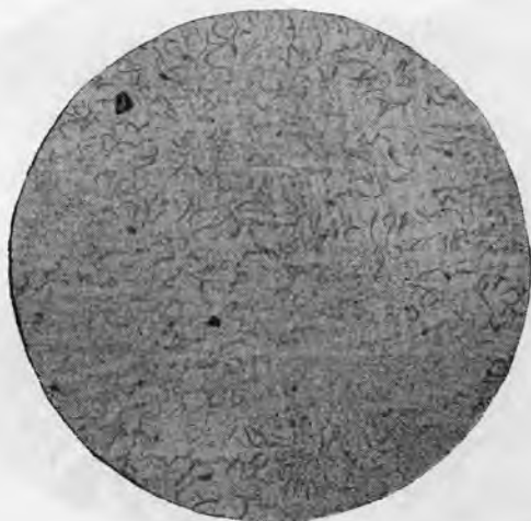
Рис. 209. Строение колоний графитной эвтектики около поверхности отливки. Не травлено, \times 50
