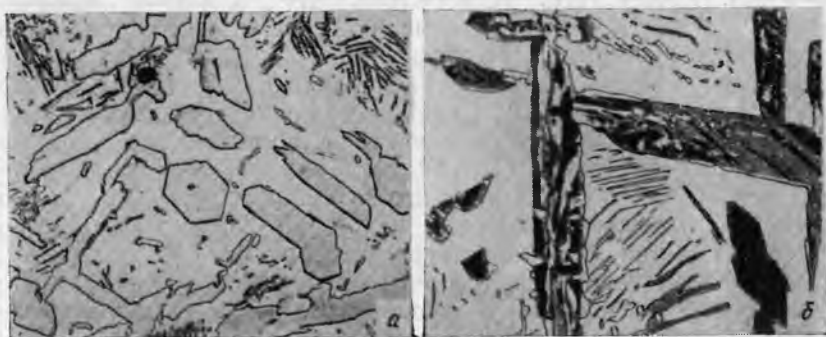
Рис. 233. Колонии карбидного эвтектоида в чугуне с 5,8% Si:
