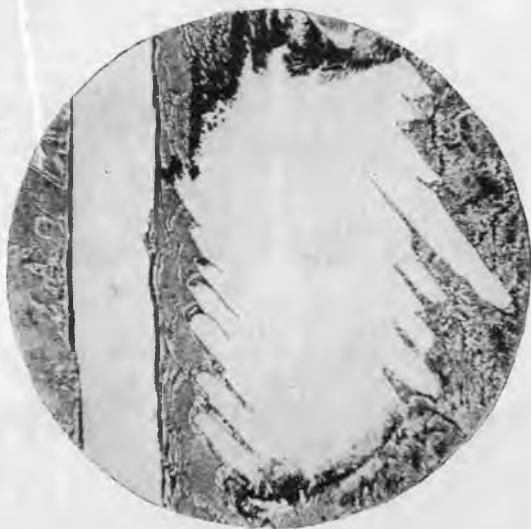
Рис. 104. Продольный и поперечный разрез кристаллов первичного цементита заэвтектического чугуна. Травление \text{HNO}_3 , \times 30
