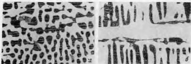
Рис. 138. Вторичный цементит в ледебуритном аустените. Травление \text{HNO}_3 , \times 500 :
