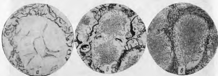
Рис. 312. Структурные изменения при аустенитизации малоуглеродистого чугуна. Травление HNO_3 :
