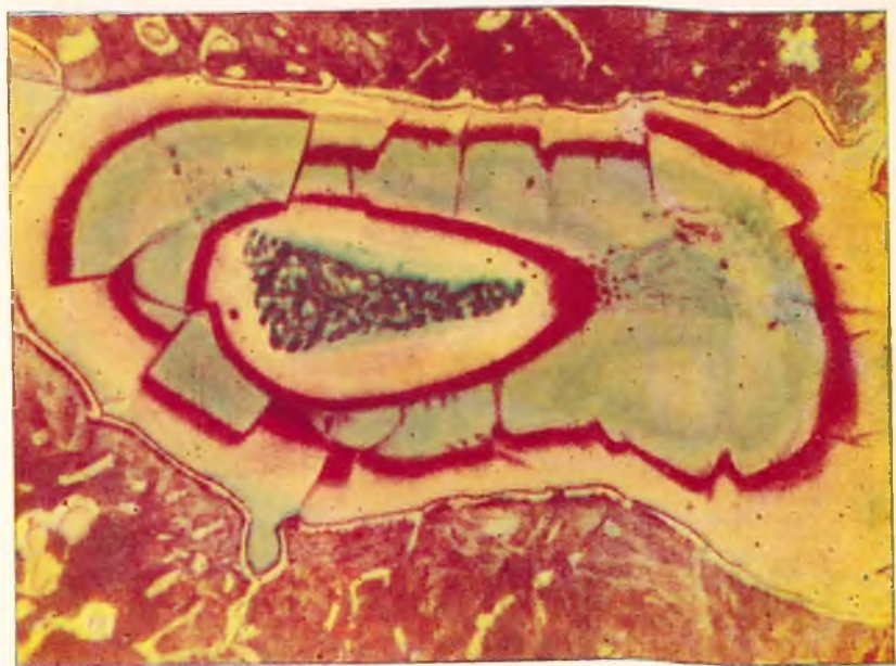
Рис. 333. Ободок ФФ при цветном травлении пикратом натрия. \times 800 .
