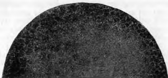
Рис. 210. Эвтектическое зерно на половине высоты цилиндрической отливки, \times 125
