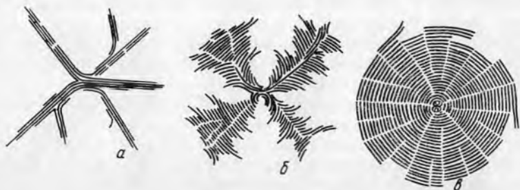
Рис. 55. Структурная схема графитных включений различной формы
