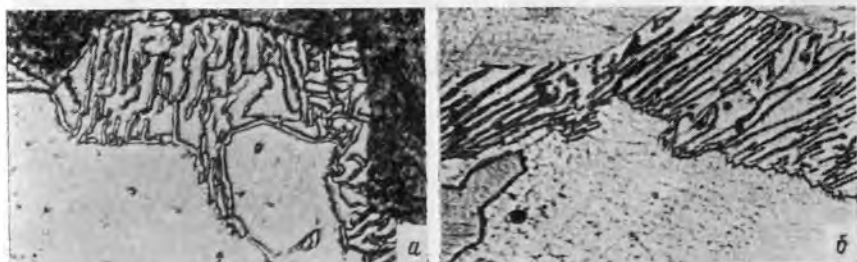
Рис. 272. Начальные стадии образования перлита. Травление \text{HNO}_3 , \times 1000
