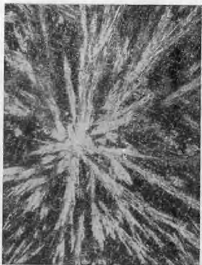
Рис. 174. Сферолит эвтектики A + (Cr, Fe)_7C_3 . Тепловое травление. \times 30
