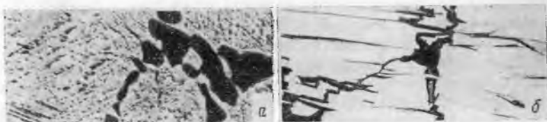
Рис. 288. Строение белого чугуна с вторичным (а) и первородным (б) аустенитом. Травление пикратом натрия, \times 400
