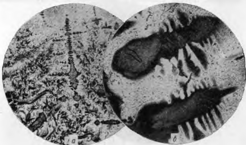
Рис. 208. Увеличение разветвленности дендритов аустенита в зоне теплового центра. Травление пикратом натрия: а — \times 50 ; б — \times 600
