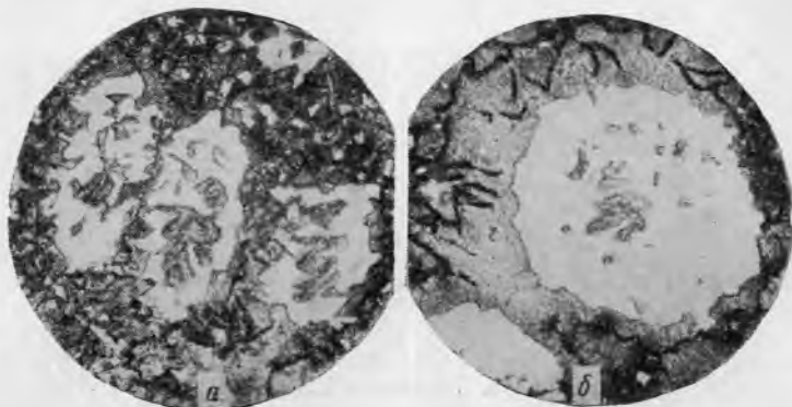
Рис. 313. Аустенитизация чугунов со слабо выраженной прямой ликвацией кремния в дендритных ветвях. Травление \text{HNO}_3 , \times 300
