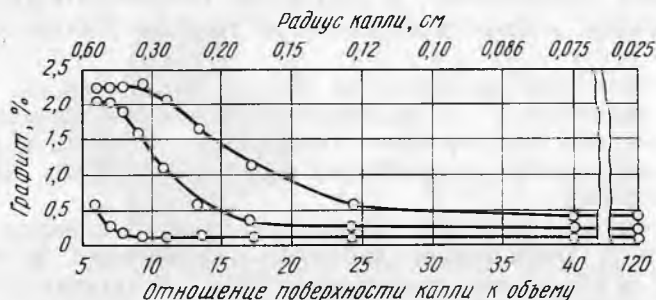
Рис. 9. Влияние скорости охлаждения капель жидкого чугуна на содержание графита
