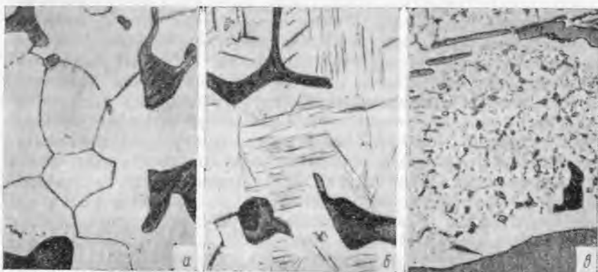
Рис. 284. Вид заэвтектоидного цементита в белых чугунах. Травление пикратом натрия, \times 500
