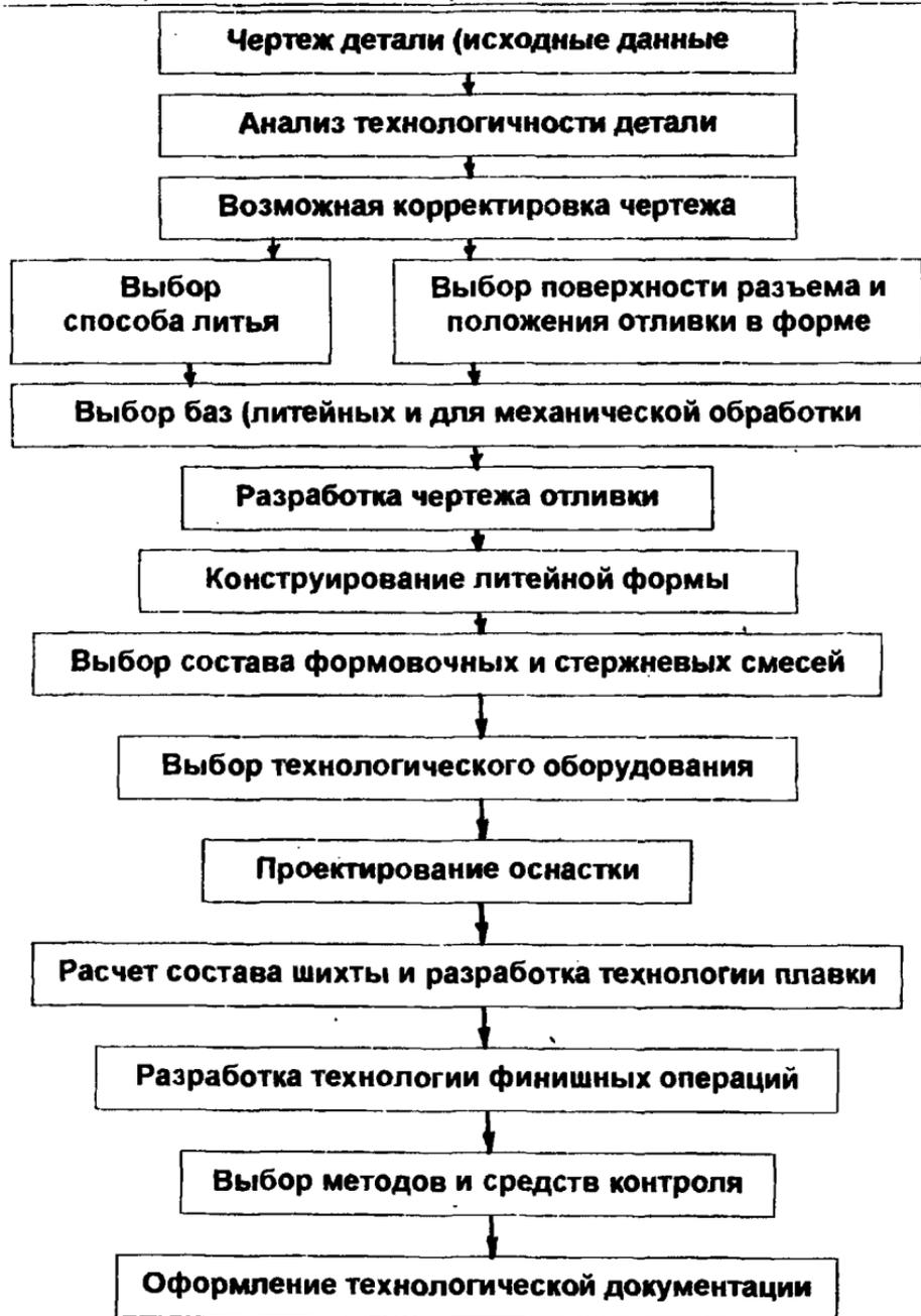
Рис. 2.36. Схема последовательности разработки технологического процесса изготовления отливки
