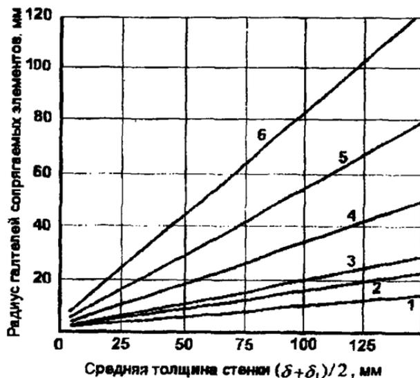
Рис. 1.30. Номограмма для определения радиусов галтелей в зависимости от средней толщины стенок отливок для углов: 1 –  $\alpha > 50^\circ$ ; 2 –  $\alpha > 60^\circ$ ; 3 –  $\alpha > 75^\circ$ ; 4 –  $\alpha > 105^\circ$ ; 5 –  $\alpha > 135^\circ$ ; 6 –  $\alpha > 165^\circ$
