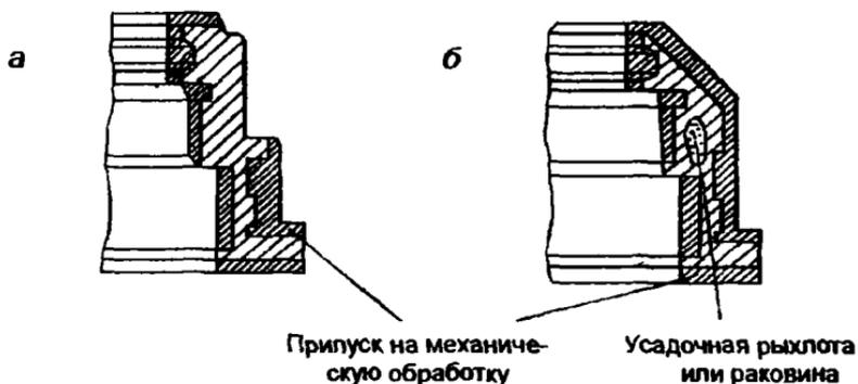
Рис. 1.17. Исполнение детали «Корпус»: а – технологичное; б – нетехнологичное
