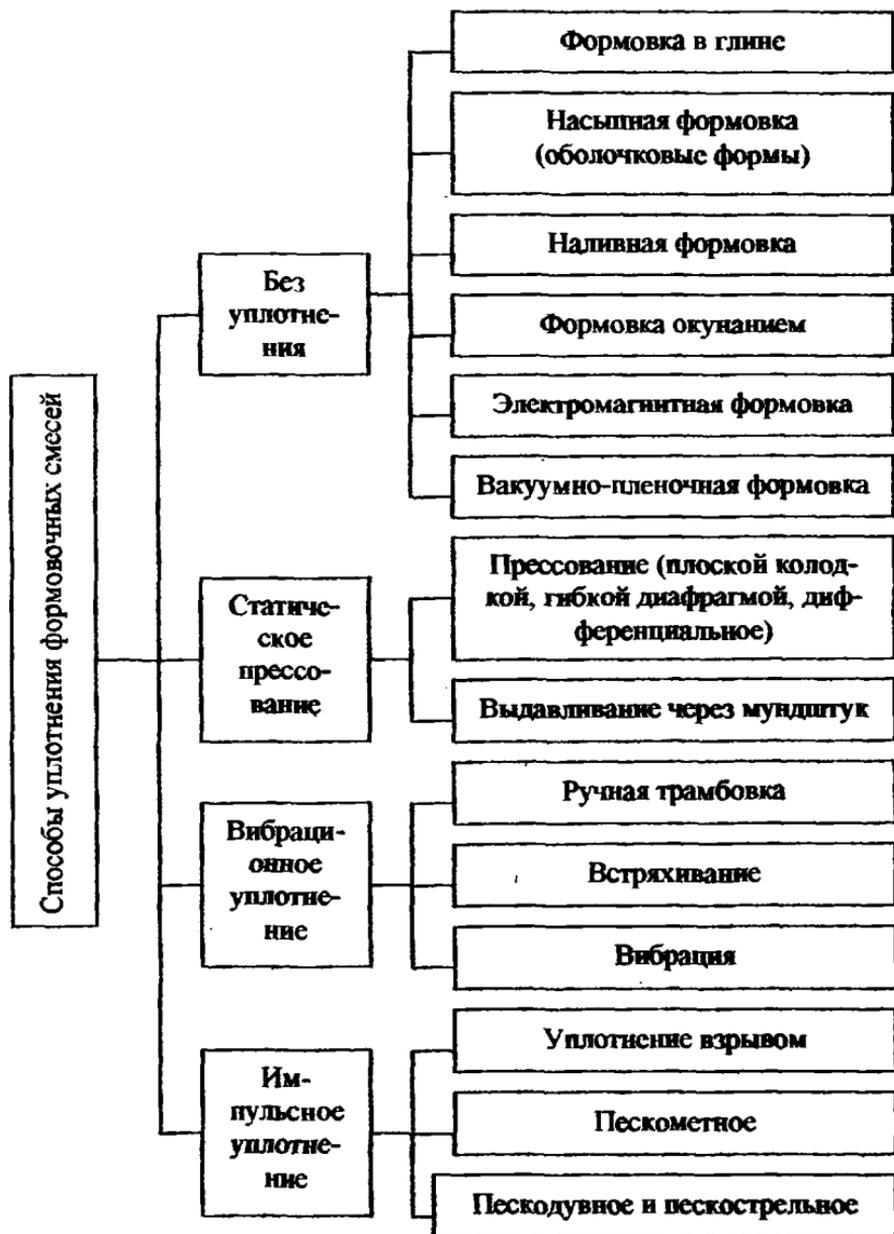
Рис. 7.1. Классификация способов уплотнения формовочных смесей
