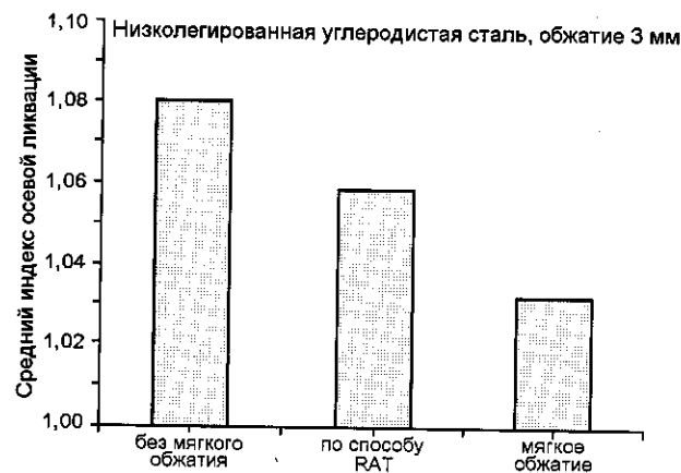
Рис. 8.25. Сравнение среднего индекса осевой ликвации при мягком обжатии по разным технологиям
