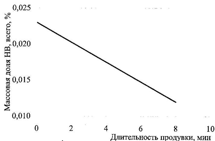
Рис. 4.7. Изменение содержания неметаллических включений в стали по ходу продувки после обработки кальцийсодержащей проволокой
