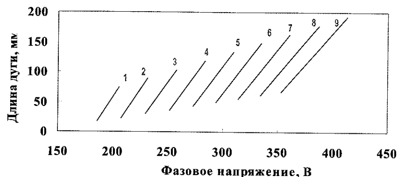
Рис.3.11. Зависимость длины дуги от величины фазового напряжения: 1–9 – ступени напряжения
