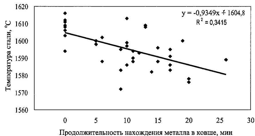
Рис. 5.8. Потери металлом температуры после выпуска плавки в сталеразливочный ковш
