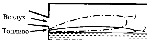
Рис. 8.10 Расположение факела в рабочем пространстве печи при равномерно распределенном (1) и прямо направленном (2) режимах радиационного теплообмена
