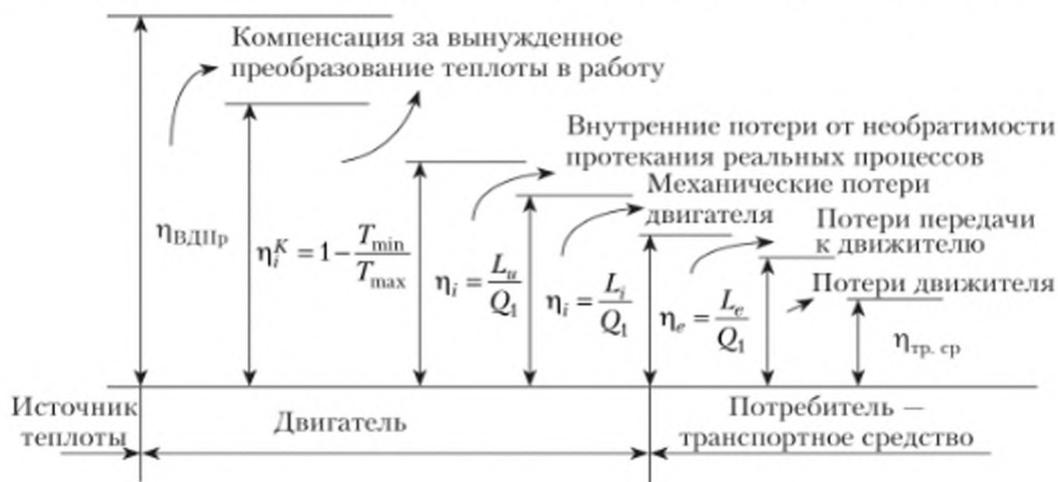
Рис. 5.9. Схема преобразования энергии от источника теплоты до потребителя
