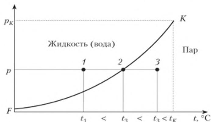
Рис. 2.13. Зависимость давления от температуры для воды и водяного пара
