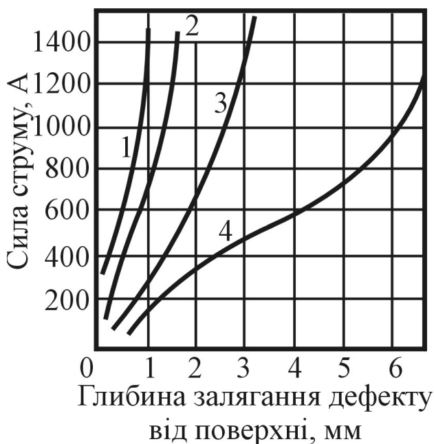
Рис.4.38. Чутливість магнетопорошкового методу залежно від сили струму і способу нанесення порошку: 1 – змінний струм „мокрий” метод; 2 – змінний струм „сухий” метод; 3 – постійний струм „мокрий” метод; 4 – постійний струм „сухий” метод
