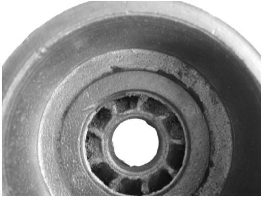
Рис.3.11. Пригар – недостатне ущільнення формувальної суміші у важкодоступних місцях та висока температура металу перед заливанням його у форму (табл.3.1, поз.2.1)
