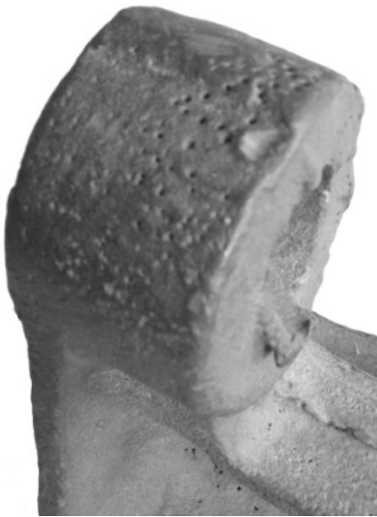
Рис.3.13. Частина сталевого вилівка, яка має декілька дефектів: залів – проникнення металу зазорами стрижневих знаків; поверхнєве ушкодження – недбале транспортування вилівка; газова шорсткість – сира форма (табл.3.1, поз.2.5; 2.9; 2.12)
