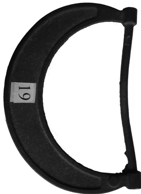
Рис.3.6. Жолоблення – невдала конструкція литої деталі та надмірно швидке охолодження виливка в ливарній формі (табл.3.1, поз.1.9)
