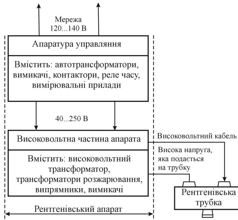
Рис.4.70. Структурна схема рентгенівської установки
