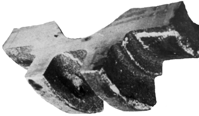
Рис.3.27. Утяжина – відсутнє підживлення рідким металом потовщених частин вилівка під час його твердіння (табл.3.1, поз.3.15)
