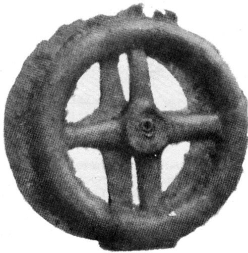
Рис.3.3. Перекіс внаслідок порушення центрування і фіксації половинок моделі на модельних плитах (табл.3.1, поз.1.5)
