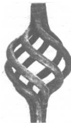
86. Декоративный элемент с использованием скручивания и горновой сварки
