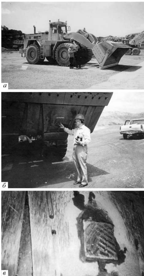
Рис. 8.5. Колесный погрузчик фирмы "Катерпиллер": a — общий вид; б — ковш с композитными плитами; в — композитная плита, приваренная к ковшу
