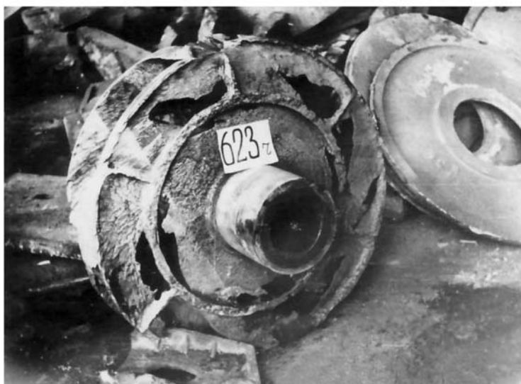
Рис. 8.2. Изношенные чугунные рабочие колеса насоса 12ГР (а, б см. текст)
