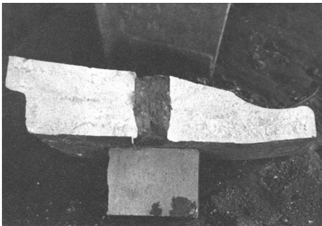
Рис. 6.20. Сечение монолитной футеровки (шаровой мельницы диаметром 3,6 м), отлитой в металлическую форму
