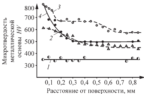
Рис. 4.10. Микротвердость металлической основы сплавов в зависимости от деформации (при обработке резанием): 1 – ИЧХ2Н4; 2 – ИЧ290Х28Н2; 3 – ИЧ260Х17Н3ГЗ; 4 – 15 % Cr–Mo (клаймэкс аллой-42)
