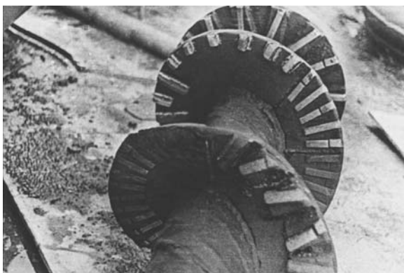
Рис. 5.14. Шнек для транспортирования абразивных материалов (композитная отливка лопасти)
