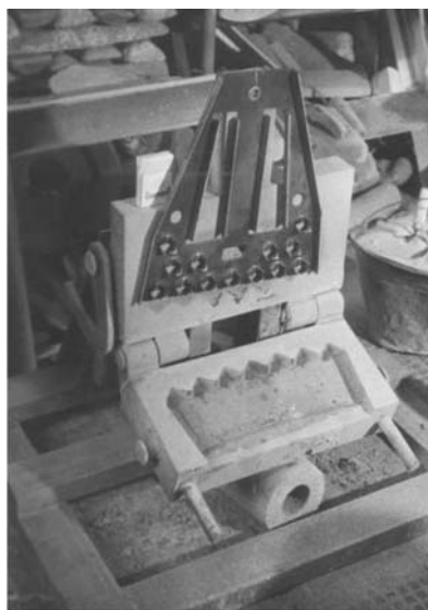
Рис. 5.8. Кокиль с установленной в него стальной штампованной частью футеровки классификатора
