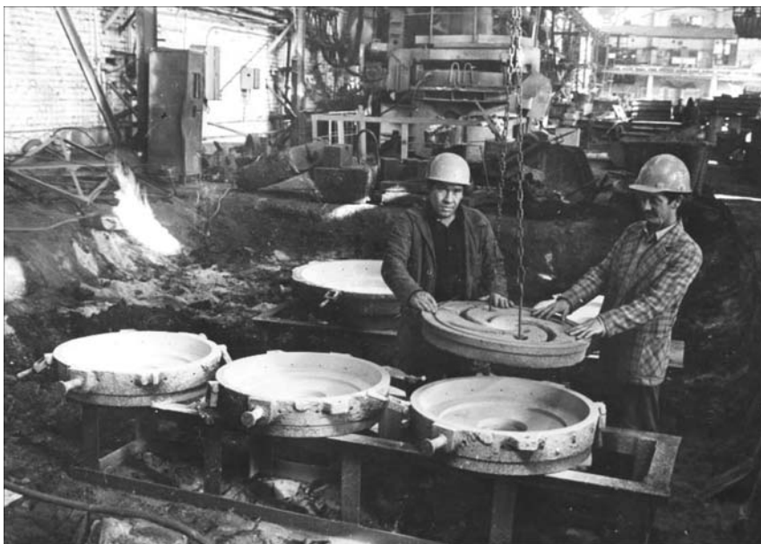
Рис. 6.8. Установка песчаного стержня в нижнюю форму кокиля
