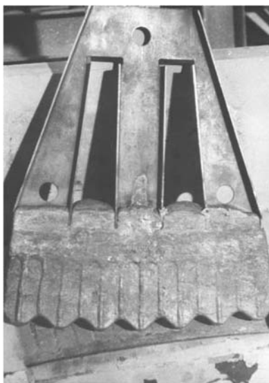
Рис. 5.7. Штампо-литая футеровка классификатора
