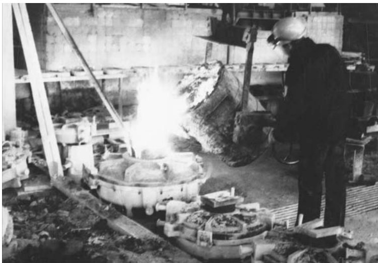
Рис. 6.10. Заливка кокиля для отливки рабочих колес
