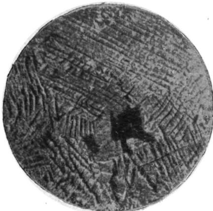
Рис. 3. Макростроение литой стали после травления (нагуральная величина). Черное пятно в центре — пора, часто встречающаяся в литом металле
