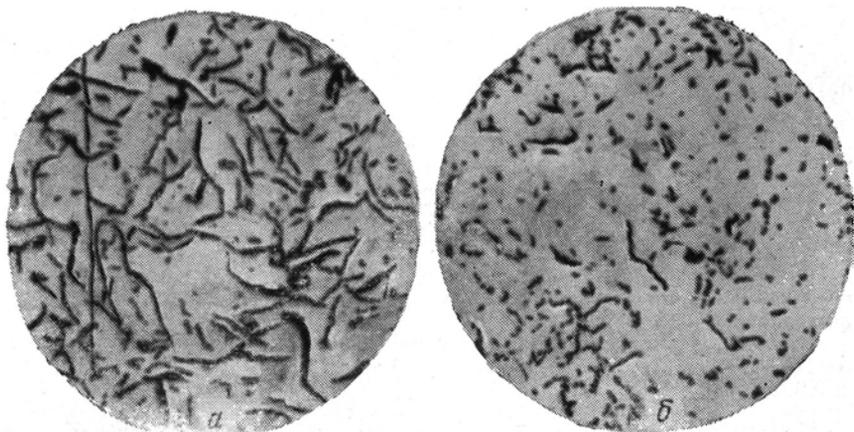
Рис. 178. Серый чугун (нетравленный шлиф).  $\times 100$ .
