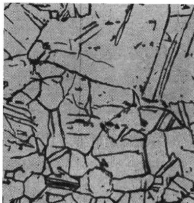
Рис. 9. Микроструктура меди.  $\times 100$
