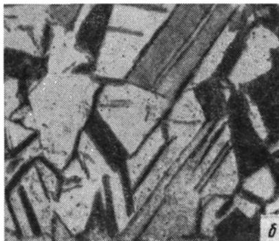
Рис. 271. Микроструктура алюминиевой бронзы (5% Al) (В. В. Жолобов, Н. И. Зедин):
