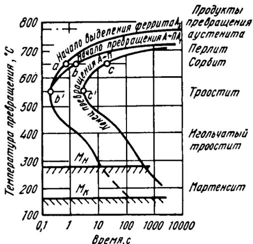
Рис. 190. Диаграмма изотермического превращения переохлажденного аустенита углеродистой стали (0,5% С)
