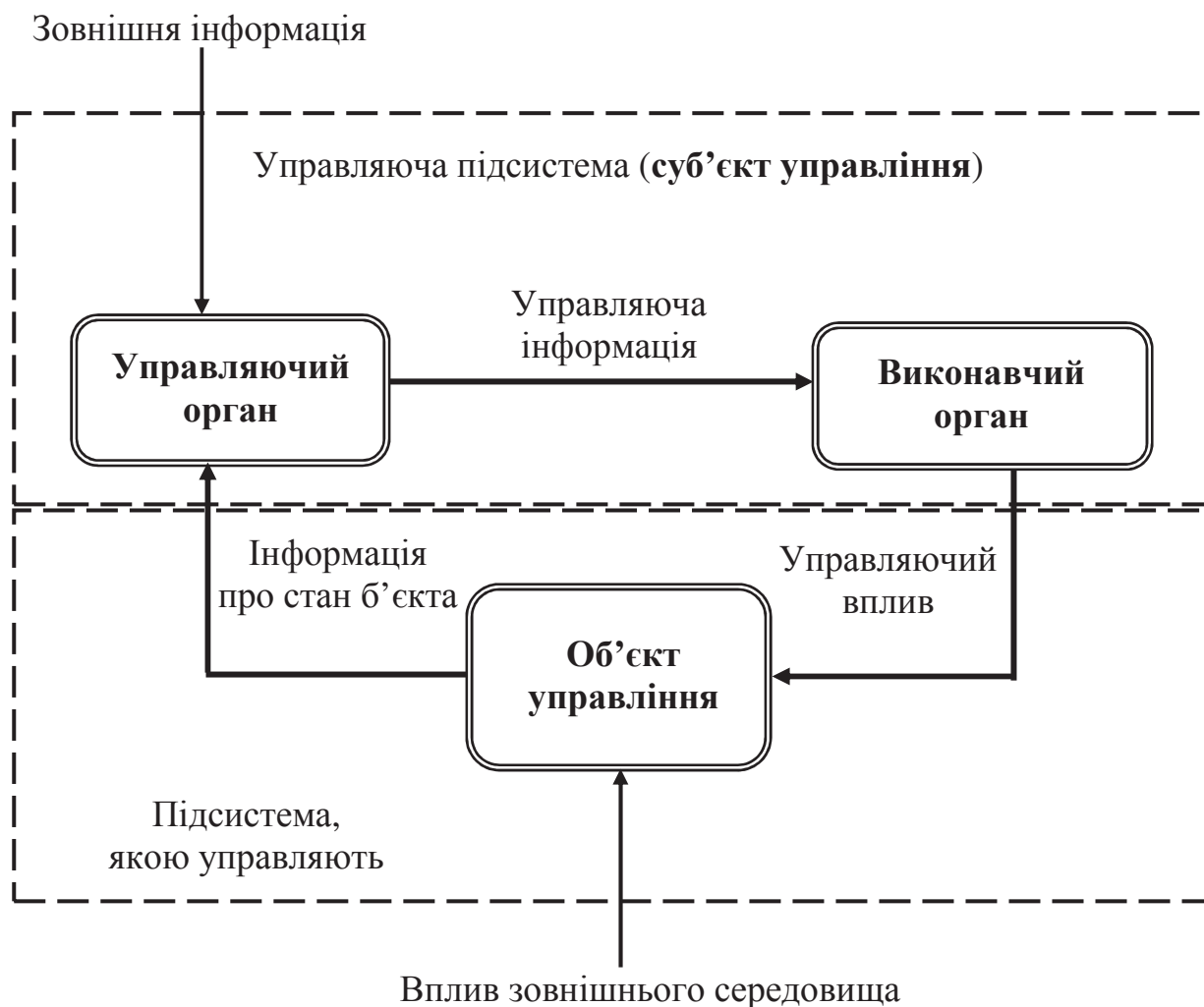
Рисунок 1.1 – Спрощена схема СУОП
