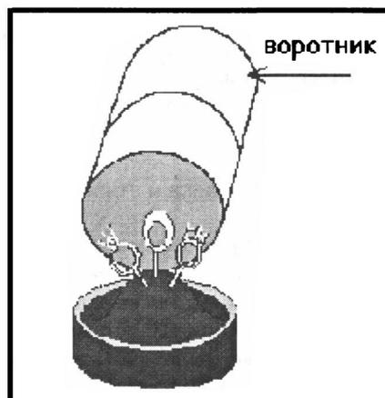
При вакуумировании, смесь поднимается и вытекает сверху через края опоки. Поэтому целесообразно на опоку устанавливать съемные воротнички, высотой от края опоки около 2,5-3 см. Воротнички можно, к примеру, изготовить из пластмассовых бутылок от воды, подобрав бутылку по диаметру опоки.
