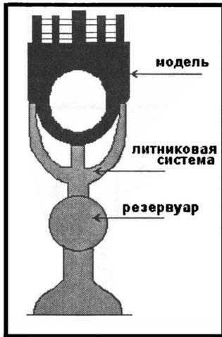
Рис. 3.41. Литниковая система с резервуаром
