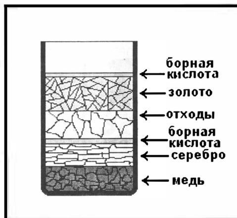
Рис. 3.32. Схема загрузки тигля
