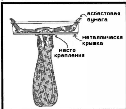
После того как металл расплавится, убирают горелку и резко прижимают металлическую крышку на форму.
