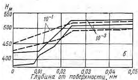
Рис. 397. Влияние термической обработки сплавов ЭП109ВД (а) и ЭИ867 (б) в вакууме на глубину изменения твердости в поверхностном слое при различном разрежении
