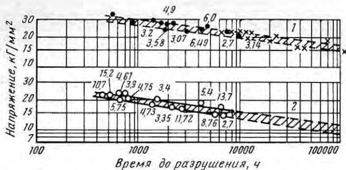
Рис. 263. Длительная прочность сплава ЭИ765 (ЦКТИ): 1 — при 700° С; 2 — при 750° С; × — расчетные значения
