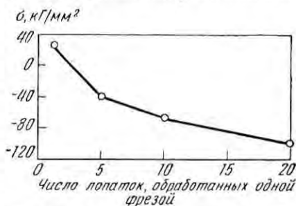
Рис. 93. Изменение остаточных напряжений при фрезеровании сплава ЭИ437Б в зависимости от состояния инструмента (затупления фрезы)
