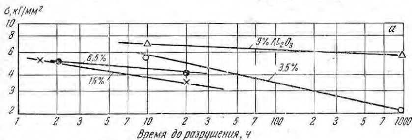
Рис. 326. Влияние содержания Al_2O_3 на длительную прочность сплава Ni- Al_2O_3 при 800^\circ C и \sigma = 3,0 \text{ кг/мм}^2
