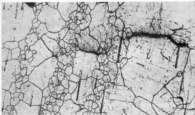
Рис. 30. Образование трещин в сплаве ЭИ437 на стыке крупных кристаллов при испытании на длительную прочность ( 800^{\circ}\text{C} , \sigma = 16 \text{ кг/мм}^2 )
