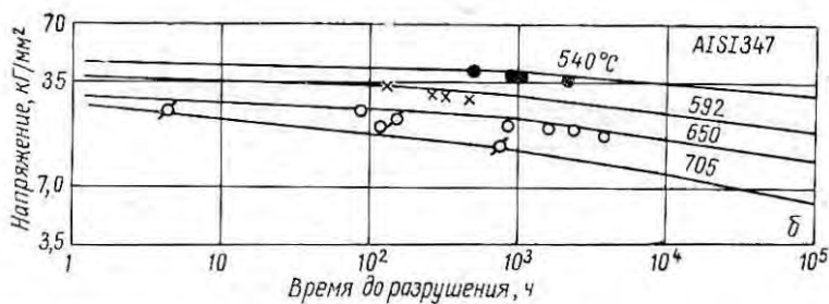
Рис. 399. Длительная прочность (а) и ползучесть (б) сплавов, испытанных в среде жидкого натрия (1) и на воздухе (2) при различных температурах
