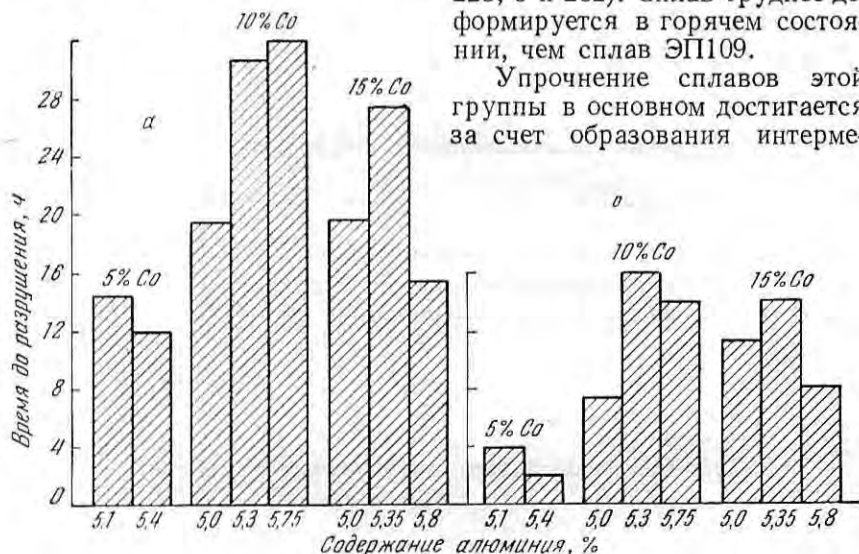
Рис. 283. Влияние содержания алюминия и кобальта на длительную прочность сплава типа ЭИ867:
