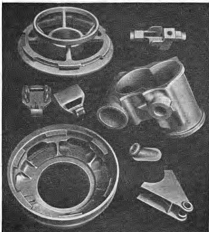
Рис. 203. Вид отливок, изготовленных методами точного литья
