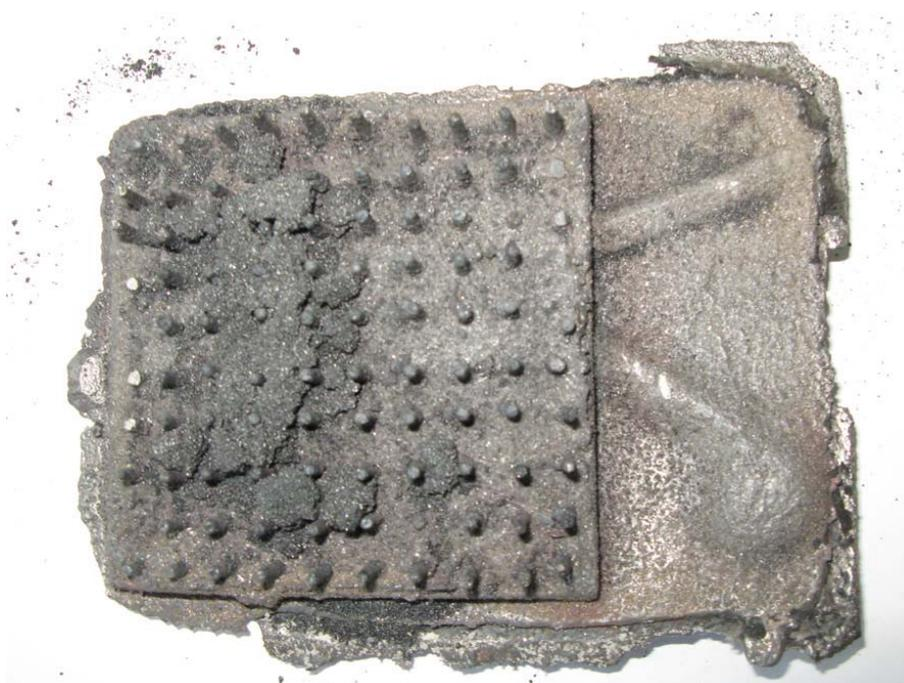
Рисунок 3.5 – Отливка, полученная в форме из ХТС
