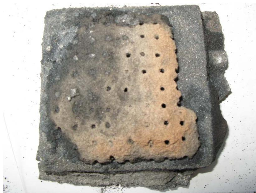
Рисунок 3.7 – Отливка, полученная в форме из стержневой смеси
