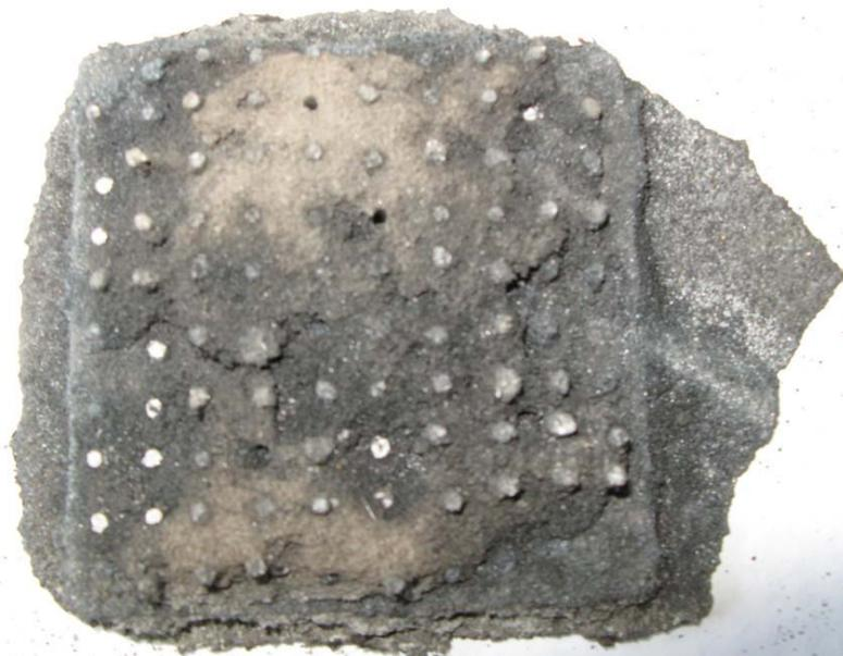
Рисунок 3.8 – Отливка, полученная в форме из стержневой смеси с добавлением глины
