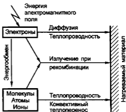
Рис. 19.3. Схема преобразования и передачи энергии в установках плазменного нагрева
