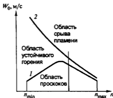
Рис. 18.23. Зависимость устойчивости факела от состава горючей смеси:
