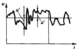
Рис. 10.1. Изменение скорости в функции времени для турбулентного потока
