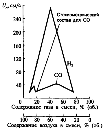
Рис. 18.16. Зависимость скорости нормального распространения пламени от состава газозвушных смесей
