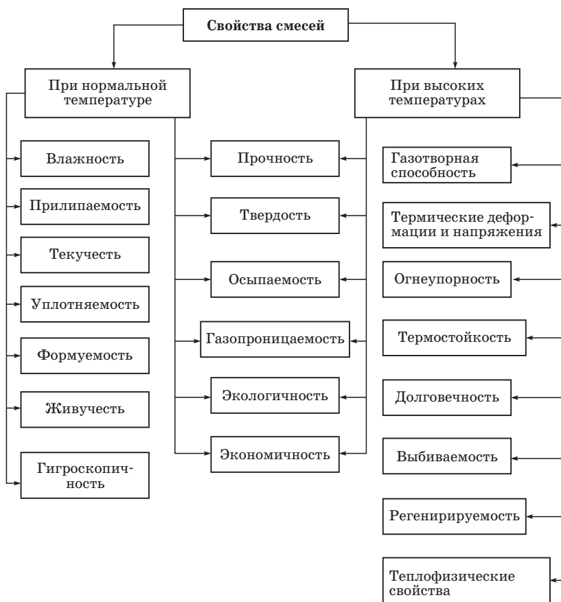
Рис. 7.1. Классификация основных свойств формовочных и стержневых смесей
