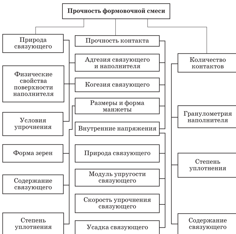
Рис. 1.4. Факторы, влияющие на прочность формовочных смесей
