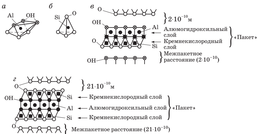
Рис. 4.1. Схема кристаллических решеток глинистых минералов: а — октаэдр; б — тетраэдр; в — решетка каолинита; г — решетка монтмориллонита
