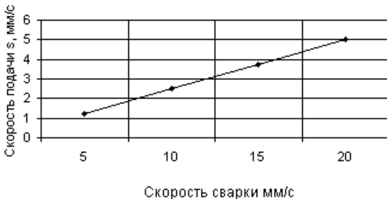
Рис. 4.36. Соотношение скоростей перемещения и подачи электрода; напряжение U=10 \text{ В} , ток I=400 \text{ А} , \eta=0,6 , N=2,4 \text{ кВт}
