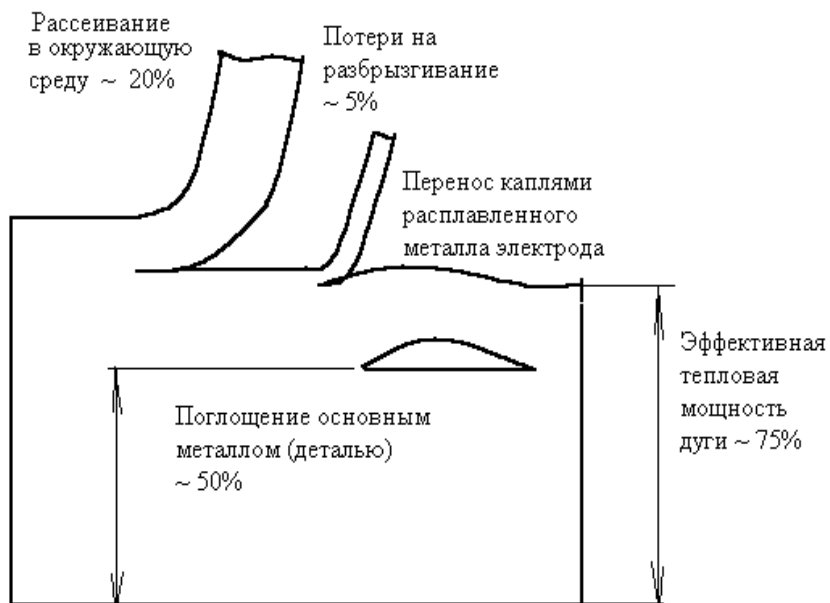
Рис. 4.26. Примерный тепловой баланс при дуговой сварке (по Н.Н. Рыкалину)
