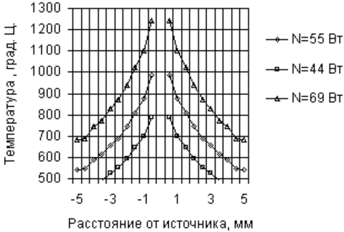
Рис. 4.64. Установившееся распределение температуры в стальной пластине \delta=1 мм, b=0,0028 1/с, \omega=8 мм 2 /с, \lambda=0,04 Вт/(мм*К).
