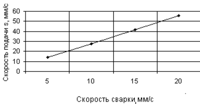
Рис. 4.31. Баланс тепловых потоков при автоматической дуговой сварке (а) и соотношение скоростей перемещения и подачи электрода (б)
