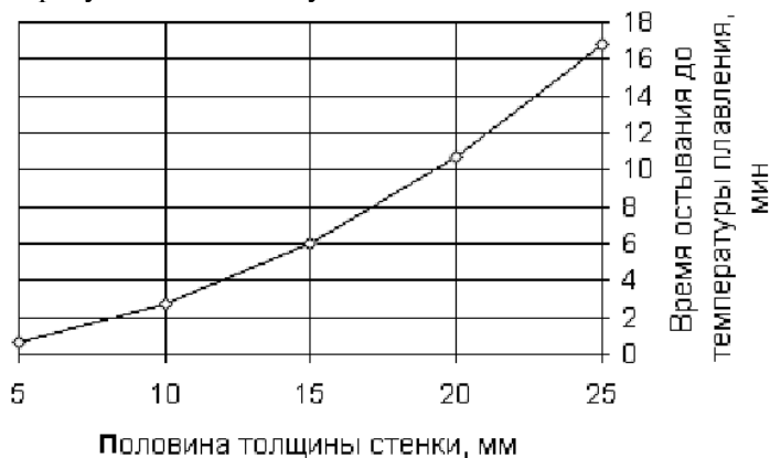
Рис. 1.22. Влияние толщины стенки на время остывания отливки от заливки расплава до начала кристаллизации отливки при теплофизических характеристиках формовочной смеси \omega_{\phi} = 0,14 \cdot 10^{-6} \text{ м}^2 / \text{с} , C_{V\phi} = 0,51 \text{ МДж} / (\text{м}^3 \text{ К}) , и теплоемкости литейного сплава C_V = 6 \text{ МДж} / (\text{м}^3 \text{ К})
