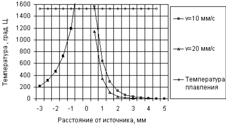
Рис. 4.54. Распределение температуры в стальной пластине \delta = 3 мм при шовной сварке N_e = 1,2 кВт
