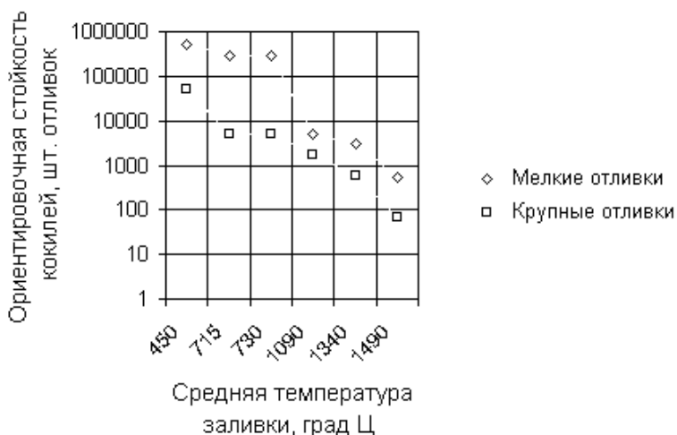
Рис. 1.32. Зависимости ориентировочной стойкости кокилей от температуры заливки сплавов
