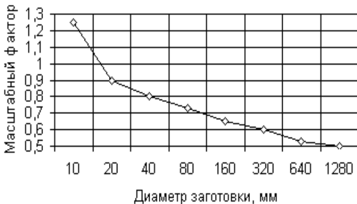
Рис. 3.9. Влияние диаметра заготовки на коэффициент \varphi , учитывающий влияние масштабного фактора на предел текучести [25]
