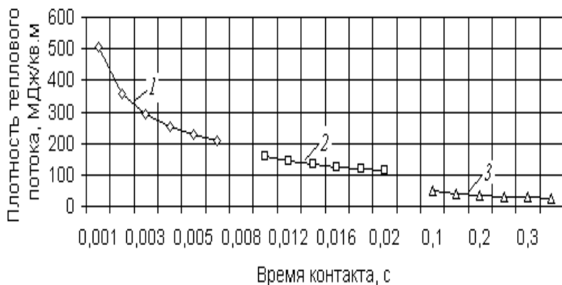
Рис. 3.61. Влияние времени контакта на среднюю плотность теплового потока: 1 – при высокоскоростной штамповке, 2 – при штамповке на молотах, 3 – при штамповке на прессах и ГКМ
