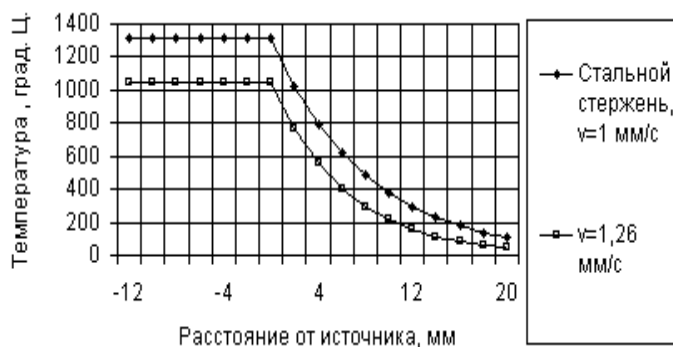
Рис. 4.18. Зависимости температуры стержня от расстояния от движущегося источника тепла с плотностью теплового потока
