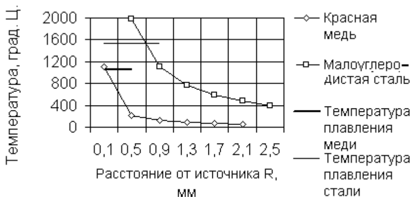
Рис. 4.19. Зависимости температуры от расстояния точки от точечного источника тепла мощностью 250 Вт, непрерывно действующего на поверхности полугораниченного тела
