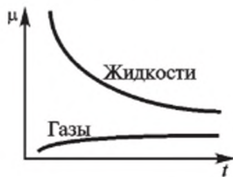
Р и с. 2.34. Зависимость вязкости от температуры
