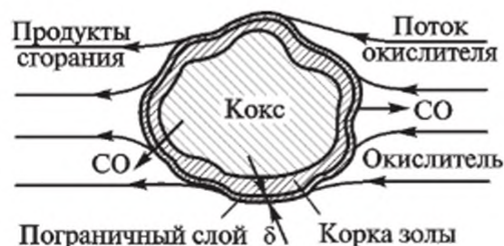
Р и с. 3.5. Схема выгорания твердого топлива в потоке воздуха
