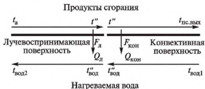
Р и с. 3.11. Схема теплообмена в водогрейном котле без хвостовых поверхностей
