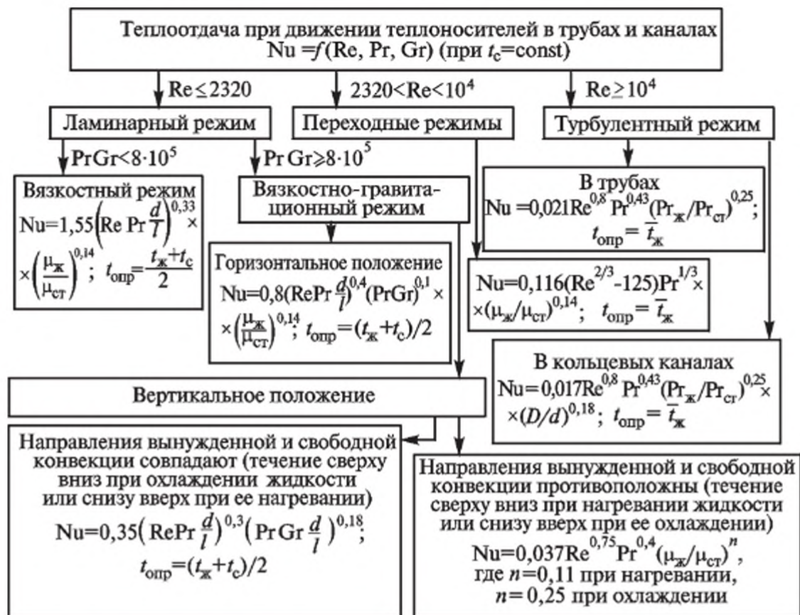
Р и с. 2.46. Критериальные уравнения теплоотдачи при движении теплоносителя в трубах и каналах
