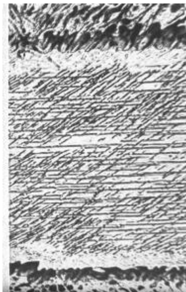
Рисунок 23 – Тонка структура кристалу цементиту, яку було отримано електролітичною поліровкою. Горизонтальні штрихи, паралельні площині (001), показують шарову субструктуру кристалу, 800 x
