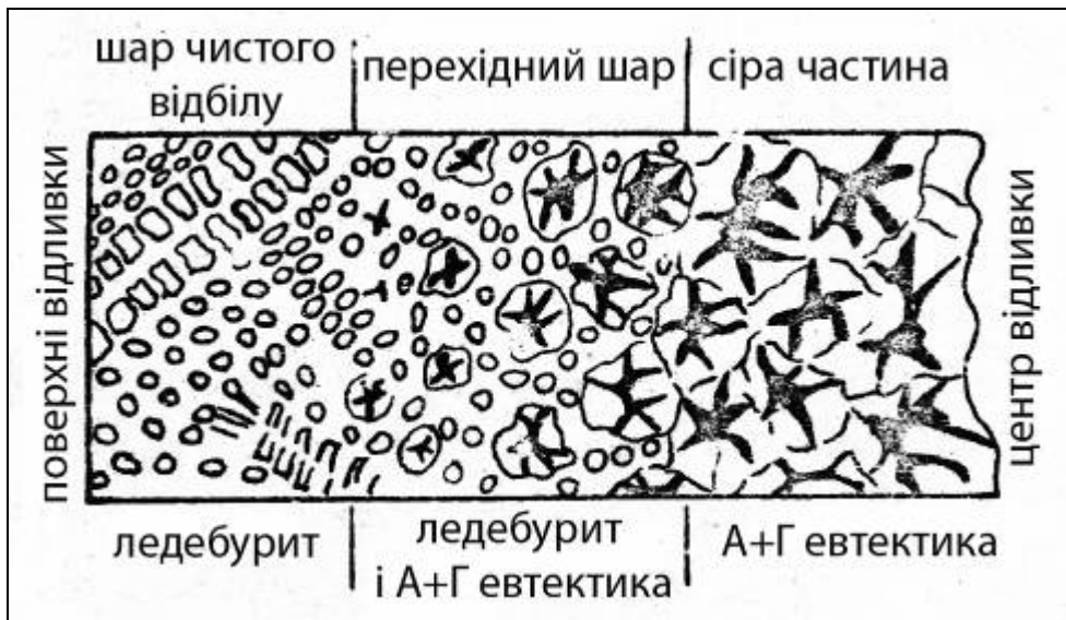
Рисунок 95 – Схематичне зображення структури відбілених чавунів
