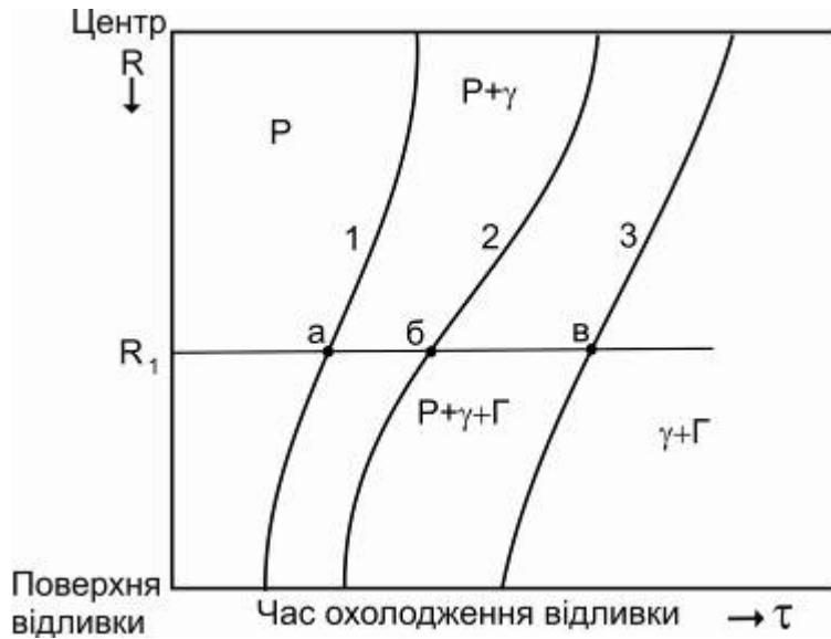
Рисунок 68 – Діаграма твердіння доєвтектичного сірого чавуну з пластинчастим графітом, що кристалізується в циліндричних відливках в земляній формі (К.П.Бунін)
