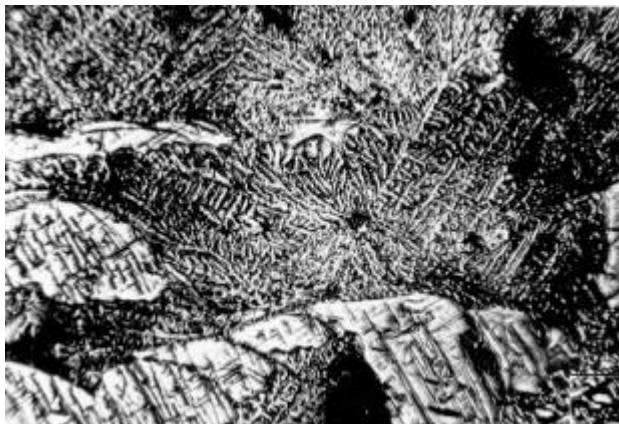
Рисунок 81 – Ріст плоского дендриту аустеніту по поверхні базового кристалу цементиту (100 x ). У центрі дендрита видно чорну точку – центр зародження дендриту
