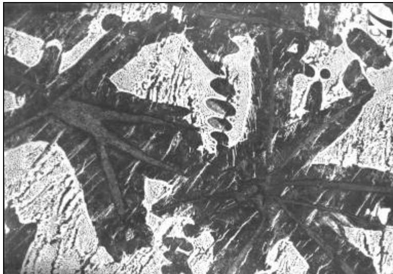
Рисунок 94 – Схематичне зображення кінцевої структури доевтектичного половинчастого чавуну (а) та мікроструктура (б)
