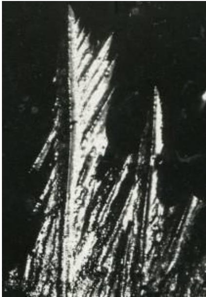
Рисунок 76 - Первинні кристали цементиту, які сформувались в усадному свищі великої відливки білого чавуну, 10^{\times}
