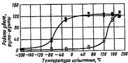
Рис. 177. Изменение ударной вязкости с температурой испытания у стали с 0,12% С, 0,5% Мп, 0,3% Si, 1,5% Cr и 3,5% Ni, производственные плавки:
