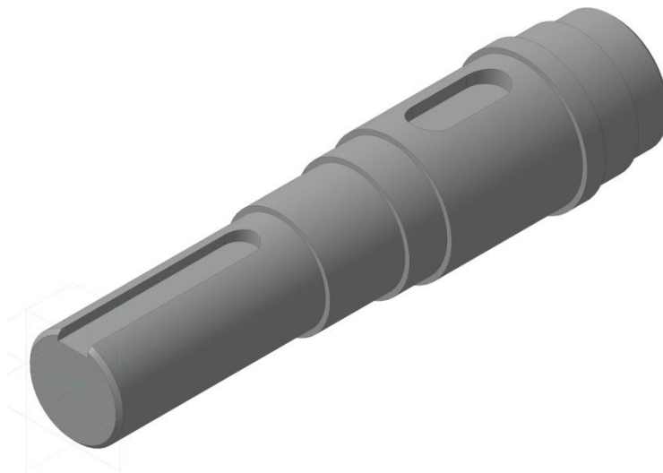
Рис. 10. Ступінчата форма вала
