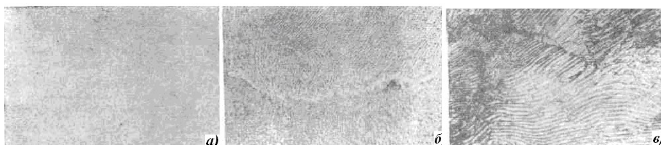
Рис. 64. Микроструктура чугунов с различной дисперсностью перлита (расстоянием между пластинами цементита), мкм: а — до 0,3; б — 0,8 — 1,3; в — более 1,6, X500
