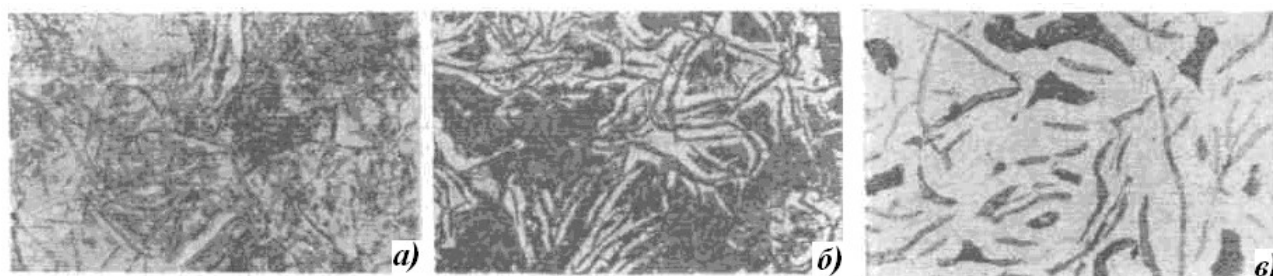
Рис. 63. Микроструктура чугунов с различным содержанием перлита в металлической основе, %: а — 94 — 98; б — 30—60; в — 2—10, X100
