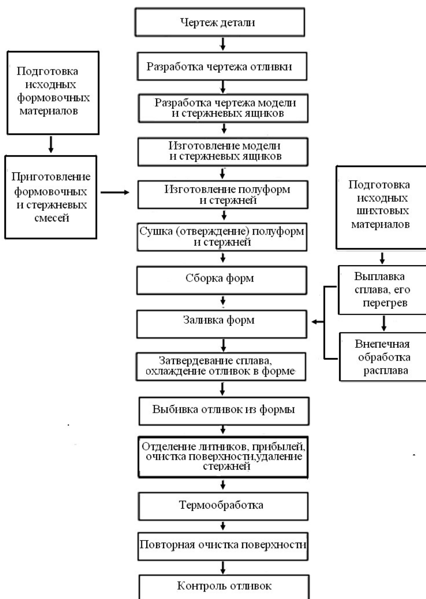
Рис. 1.1. Технологический процесс получения отливок в разовой песчаной форме
