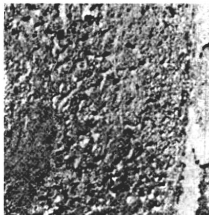
Рис. 17.36. Газовая шероховатость, возникшая при использовании неочищенного холодильника
