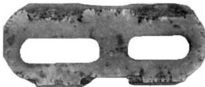
Рис. 17.87. Ситовидные раковины в сечении стальной отливки
