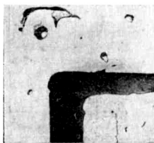
Рис. 17.69. Газовые раковины от брызг металла
