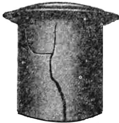
Рис. 17.38. Холодная трещины в отливке при плохой податливости стержня
