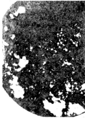
Рис. 17.74. Отпечаток по Бауману на дефектной чугуновой отливке (вторичный шлак содержит много MgS )
