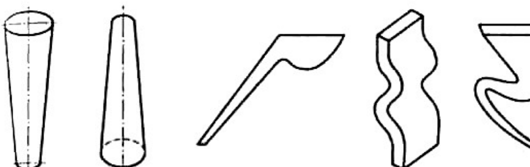
Рис. 11.10. Виды стояков: а – вертикальный с уклоном; б – вертикальный с обратным уклоном; в – наклонный; г – зигзагообразный; д – «гусиная шейка»; е – продольное сечение стояка в виде свободно падающей струи
