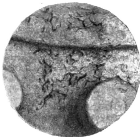
Рис. 17.34. Складчатость на поверхности отливки нажимного диска грузового автомобиля
