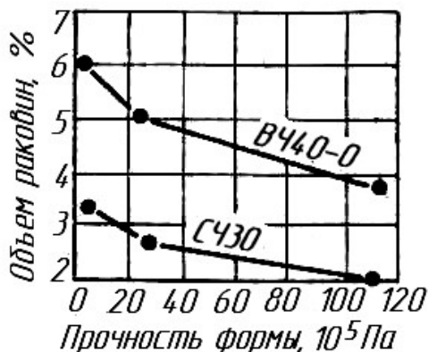
Рис. 17.104. Влияние прочности литейной формы на объем раковин в отливке
