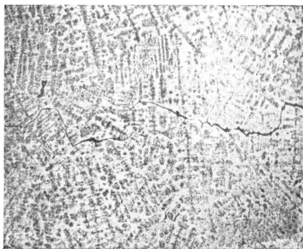
Рис. 17.41. Трещины, располагающиеся между зернами грануляционной структуры, без ориентировки по отношению к дендритам (x 6).
