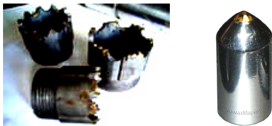
Рис. 5.20. Режущий инструмент с закреплением кристалла СТМ в оправке
