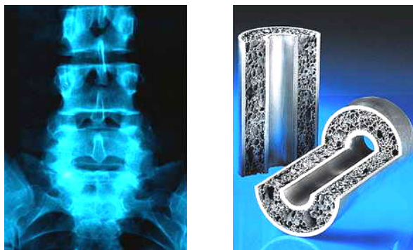
Рис. 4.26. Биологически совместимый протез костной ткани и полые изделия с жесткостью за счет металлический пены
