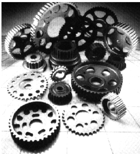
Рис. 3.22. Детали, изготовленные горячим прессованием
