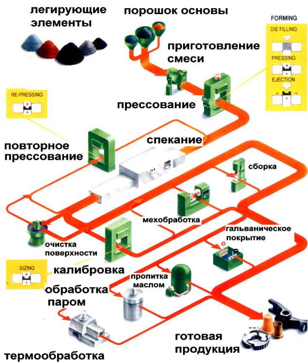
Рис. 3.15. Технологическая схема с двойным соосным прессованием, двойным спеканием и калибровкой
