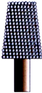
Рис. 5.25. Конструкция цельно-алмазного инструмента
