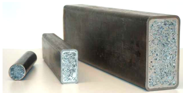
Рис. 4.5. Композитные изделия из листового каркаса и вспененной сердцевины
