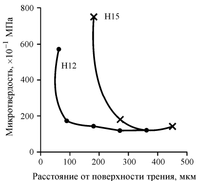
Рис. 6.8. Изменение микротвердости в зоне трения по стали вглубь от поверхности контакта
