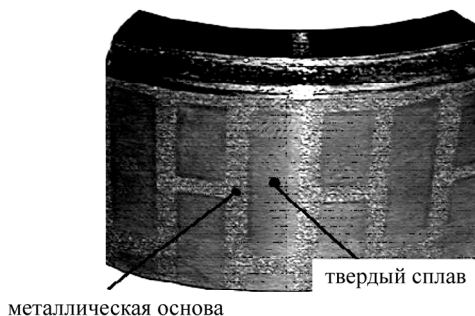
Рис. 1.9. Защитная втулка вала, облицованная твердым сплавом
